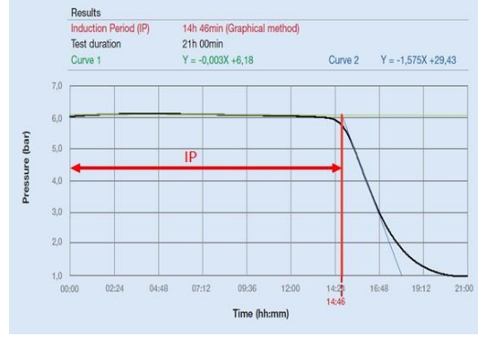
Şekil 3.8. Oksitest cihazı (Velp, İtalya) ve Oksitest eğrisi.
