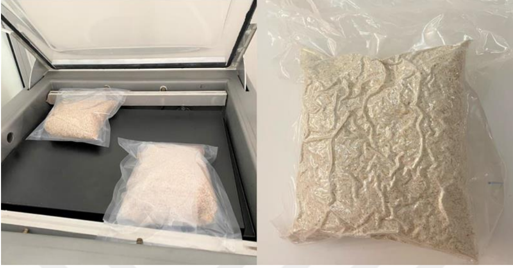
Şekil 3.5. Vakum makinesi ve vakum paketlenmiş örnek.
