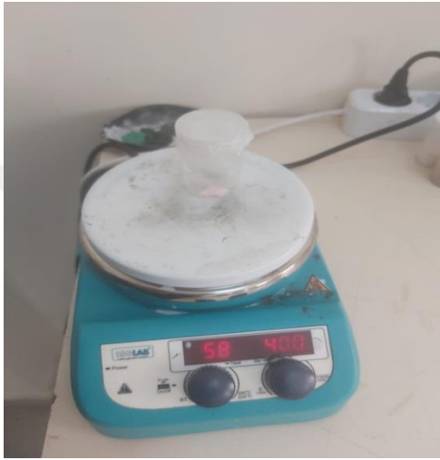
Şekil 3. 2. Manyetik karıştırıcıda karıştırılma aşaması.
