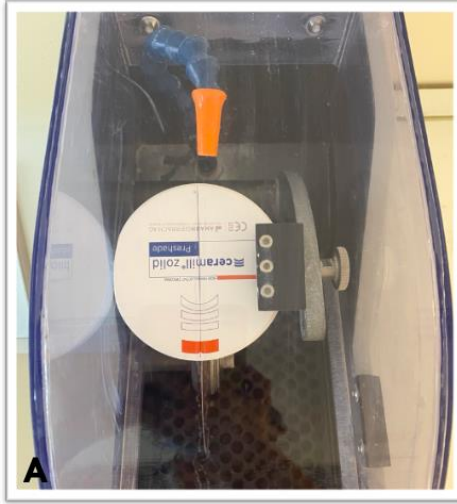
Resim 3.2. Örneklerin hassas kesim cihazında hazırlanması (A) ve CAD/CAM disklerden hazırlanan örnekler (B)
