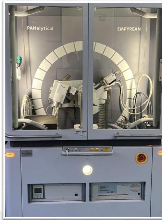
Resim 3.11. Örneklerin XRD analizi için kullanılan X-ışını difraktometre cihazı
