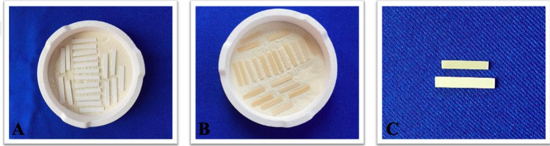
Resim 3.7. Örneklerin sinter öncesi (A) ve sonrası (B) fırın tablasında görünümü, örneklerin başlangıç ve nihai boyut farkı (C)
