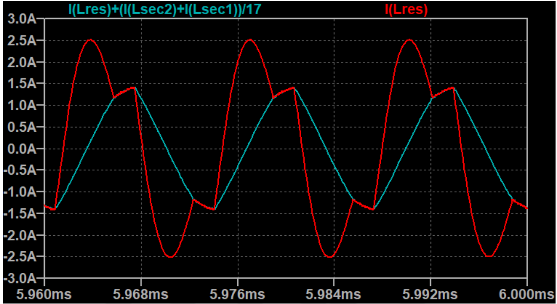
Şekil 6.11 GaN transistörlü dönüştürücü - nominal giriş geriliminde 20A çıkış akımında mıknatıslanma akımı dalga şekli simülasyon sonucu
