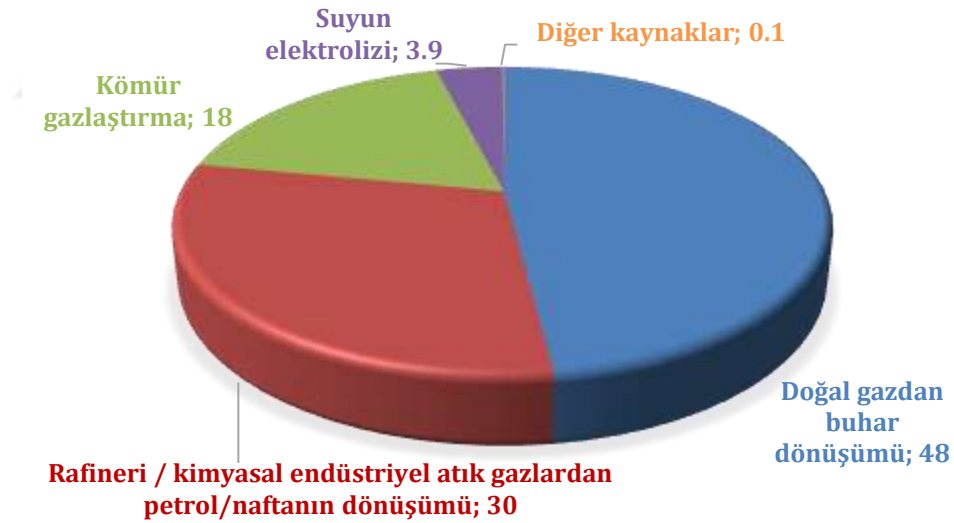
Şekil 2.4.3. Mevcut hidrojen üretiminde kullanılan yöntemler
