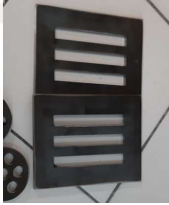
Şekil 3.34 Basınçla Kalıplama İşleminde Kullanılan Kalıp (ISO 180)
