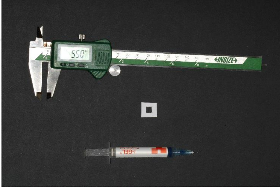
Şekil 3.3: Dental asitleme jeli (i-GEL Phosphoric Acid), orta kısmından 5,5x5,5 mm boyutlarında alan kesilerek çıkartılmış yapışkan kağıt, kumpas
