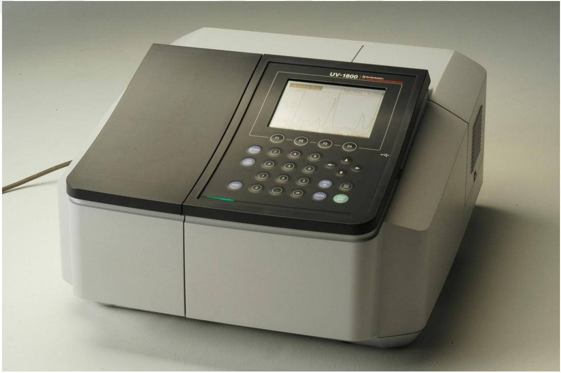
Resim 3.9. GSH, GSH-Px, ve MDA analizlerin yapıldıęı spektrofotometre cihazı, Shimadzu, UV-1800, (Japonya).
