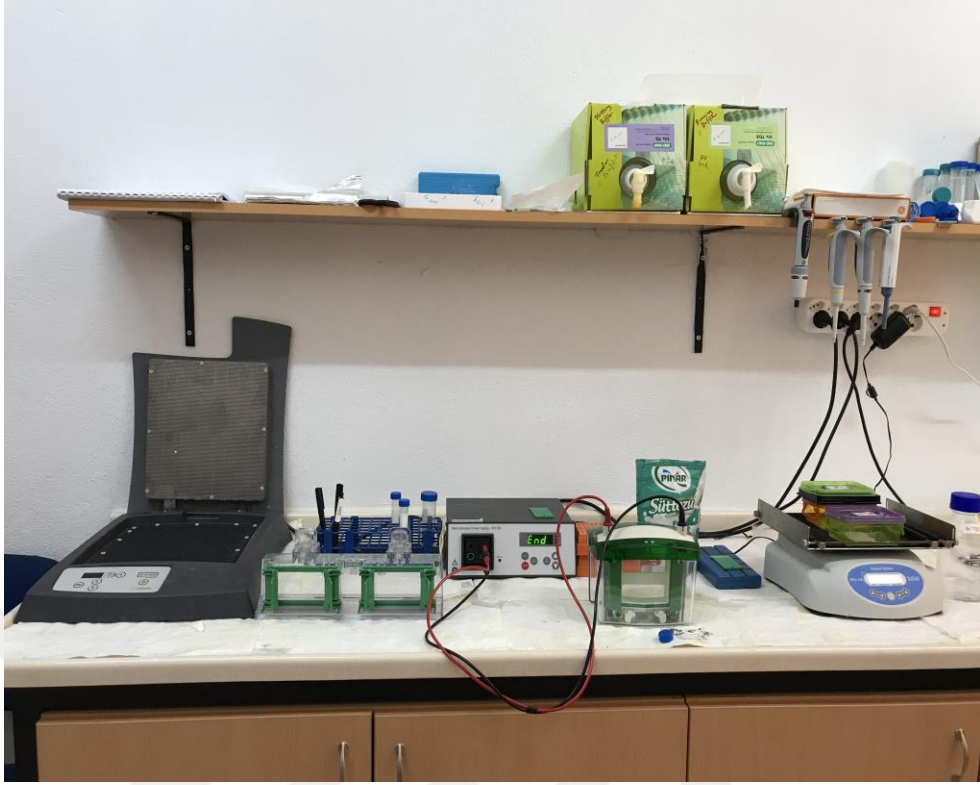
Resim 3.6. Western Blot analizinde kullanılan malzemeler
