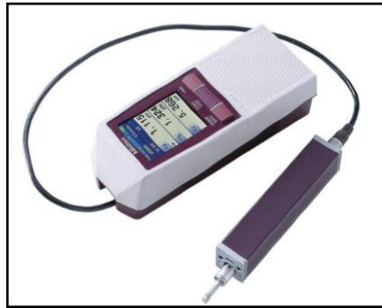
Şekil 4.6. Mitutoyo Surface SJ-210 yüzey pürüzlülük cihazı.
