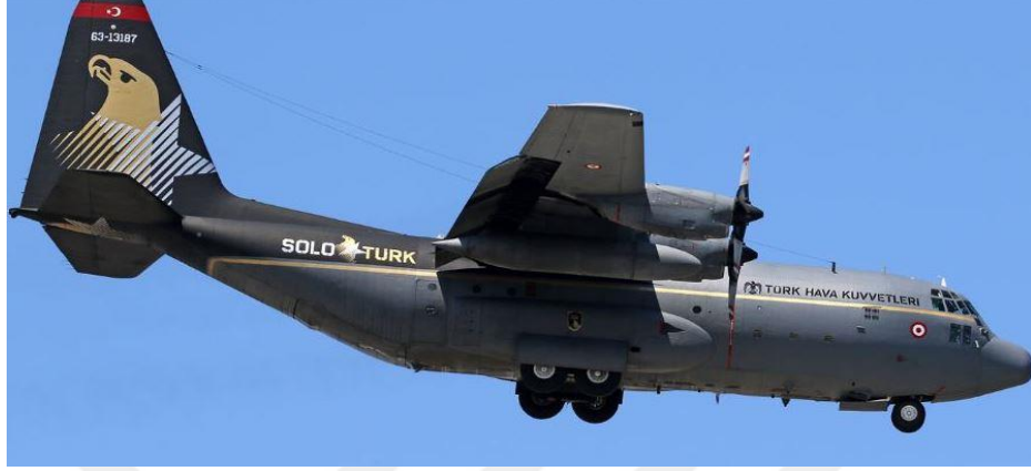
Şekil 2.6: C-130 Hercules İniş takımı konfigürasyonu.
