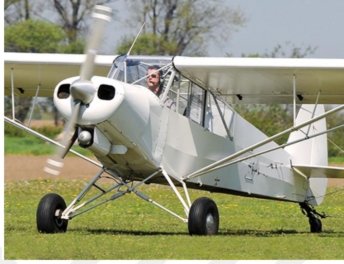
Şekil 2.9: PA-18 Super Cub İniş Takımı.
