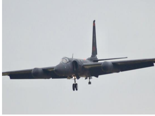
Şekil 2.5: Lockheed U-2 İniş Takımı.
