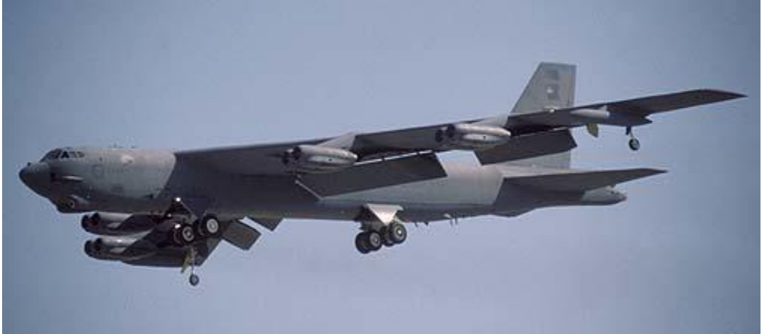
Şekil 2.7: B-52 İniş takımı konfigürasyonu.
