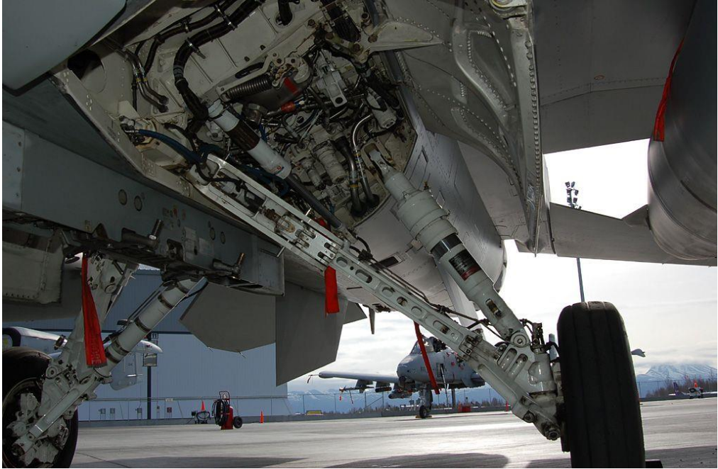
Şekil 2.11: F16-C Savaşan Şahin(Fighting Falcon) Ana iniş takımı.
