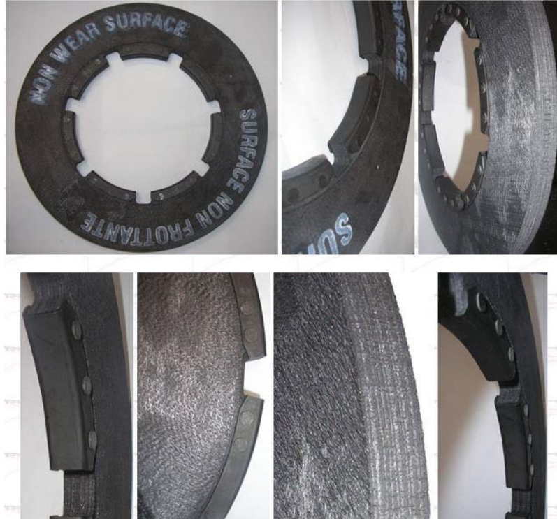
Şekil 4.31: F-16 savaş uçağı karbon fren diskleri.
