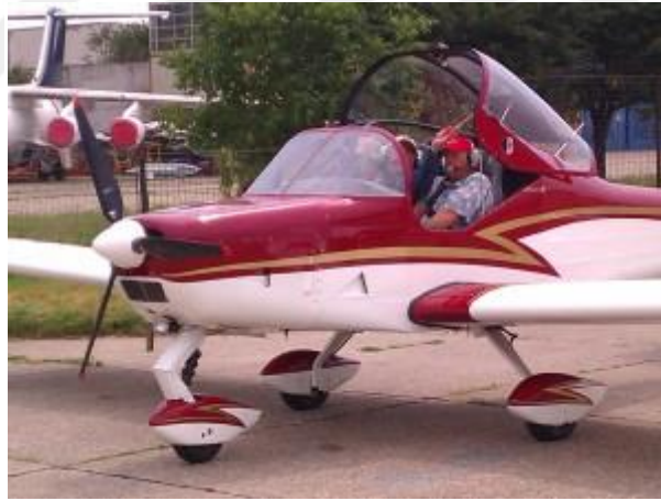
Şekil 2.8:Yaprak tipi yaylı iniş takımı.
