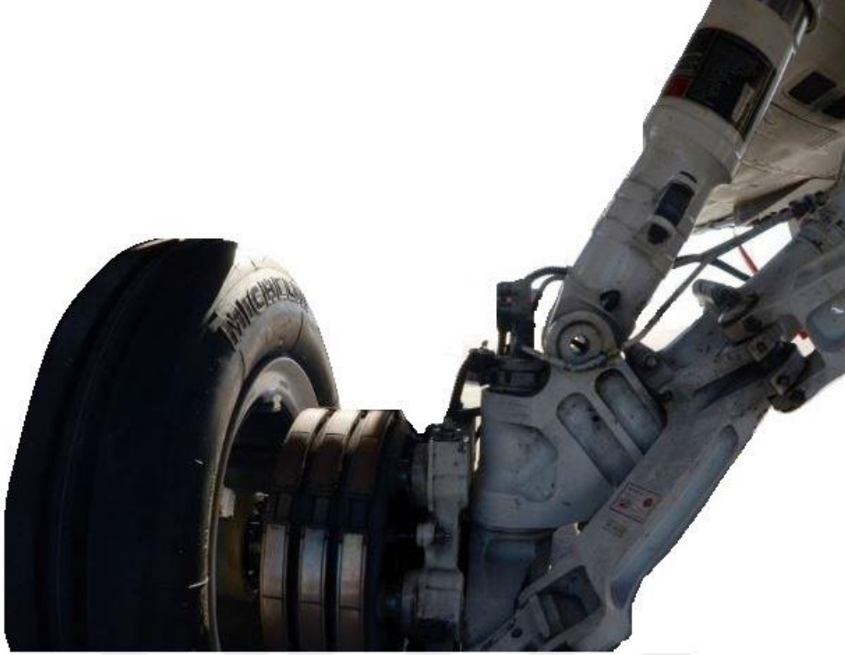
Şekil 4.29: F-16 savaş uçağı tekerlek, fren ve iniş takımı dikmeleri.
