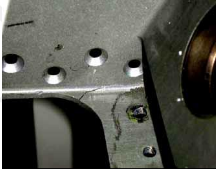
Şekil 5.7: F-16 Block-30/40/50 341 Lower Bulkhead Çatlak İlerleme.
