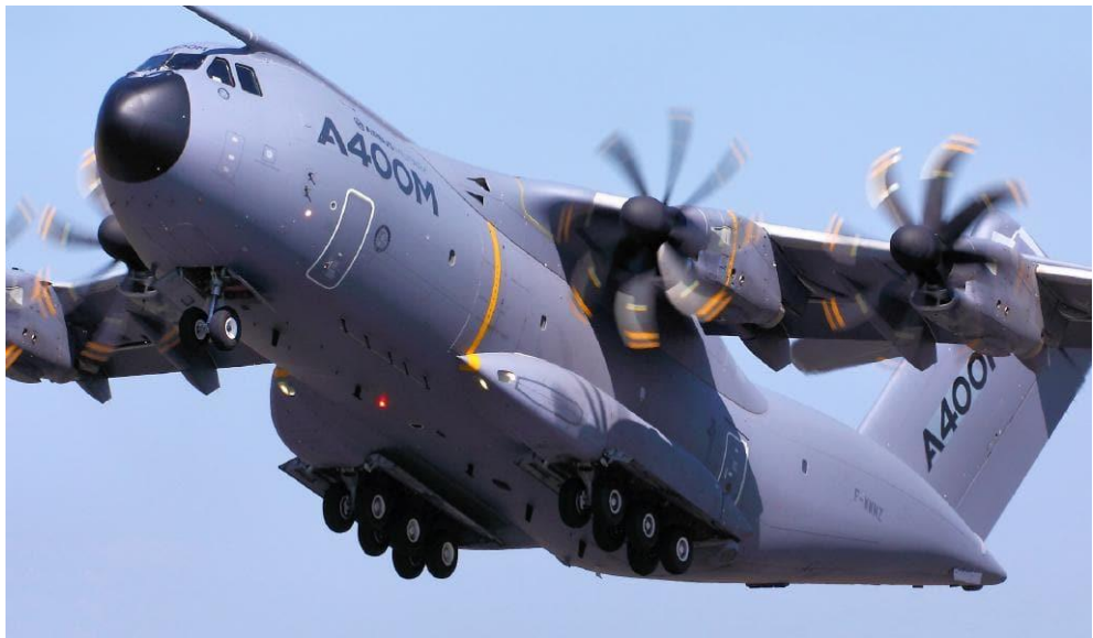
Şekil 2.10: A400M çok tekerlekli içeri çekilebilir iniş takımı.
