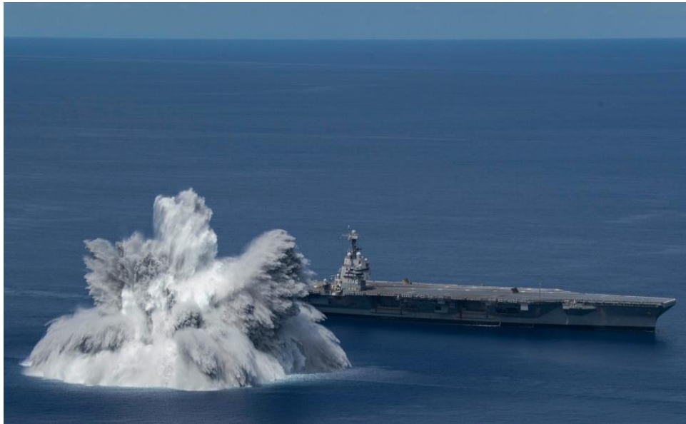
Şekil 1.7 : USS Gerald R. Ford'a istinaden yapılan şok testi [4].
