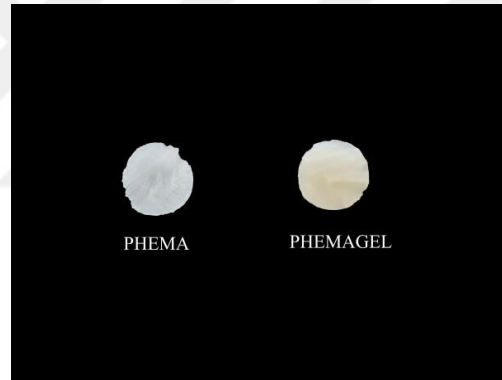
Şekil 3.2. PHEMA (beyaz) ve PHEMAGEL (sarı) kriyojellerin kesilmiş disk görüntüsü.
