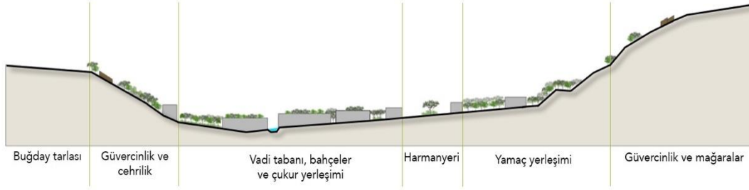
Şekil 4.26 : Gesi Vadisi’nde bulunan Mancusun köyü üzerinden yer üstü yerleşimini anlatan kesit (çukur yerleşim örneği).
