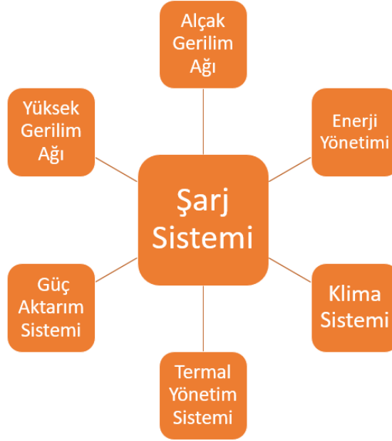
Şekil 4.3 : Şarj sisteminin diğer sistemlerle olan ilişki matrisi.
