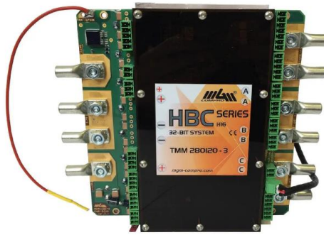
Şekil 3.4. Mgm comprow HBC280120-3 elektrik motor kontrolörü [44]
