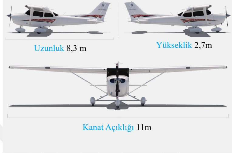
Şekil 3.7. Cessna 172S boyutları
