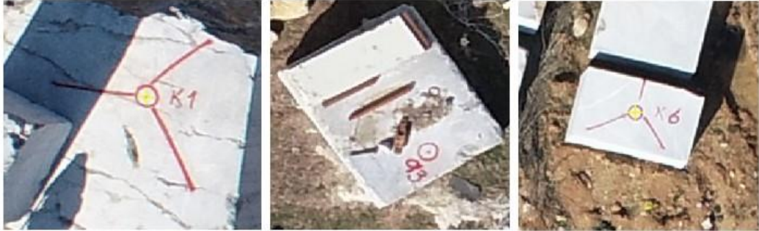
Şekil 4.12 Uçuş öncesi YKN’lerin araziye tesisi ve hava fotoğrafından görünüşleri
