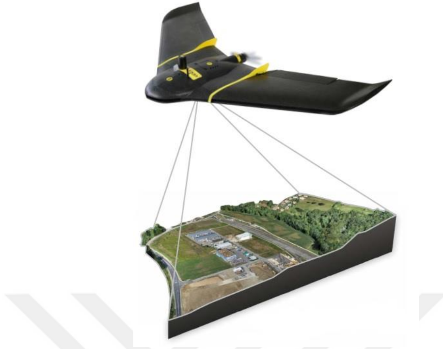
Şekil 3.1 İHA ile hava fotoğrafı alımı örnek gösterim [68]
