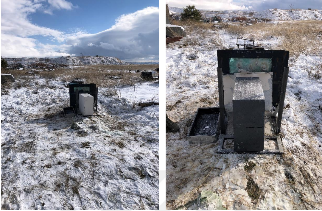
Resim 3.8. Yan yüzeyi yapıştırma harcı-sıva ve monolitik elastomer poliürea hazırlanmış numuneler
