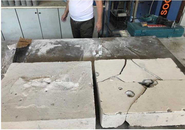
Resim 4.1. Yapıştırma harcı-sıva kaplı gazbetona yapılan atışlar
