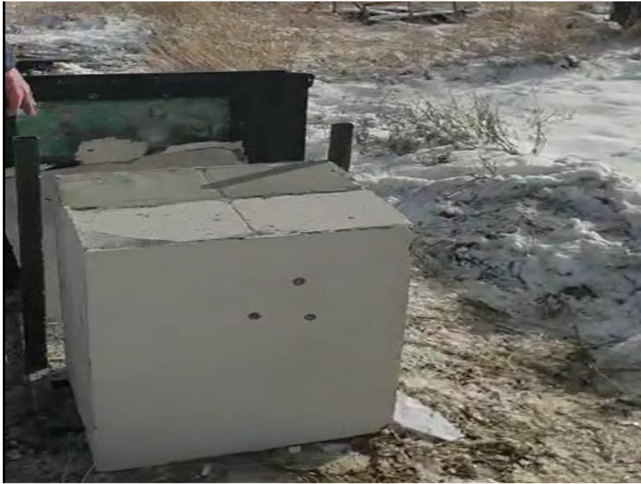
Resim 3.9. Çift sıra halinde yapıştırma harcı-sıva ile hazırlanmış numuneler
