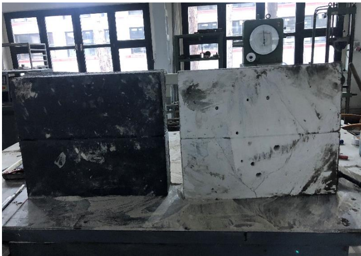
Resim 4.2. Monolitik elastomer poliürea kaplı gazbetona yapılan atışlar
