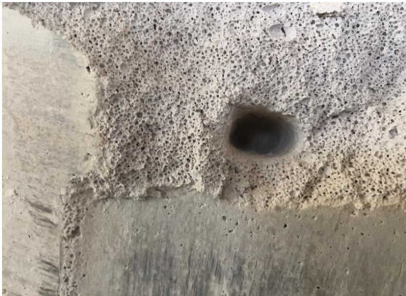
Resim 4.6. Nişasta kaplamalı gazbetonlara yapılan atışların etkisi
