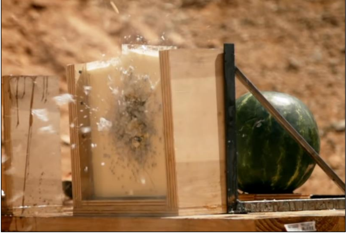
Resim 2.2. Oobleck sıvısına yapılan atış ve etkisi
