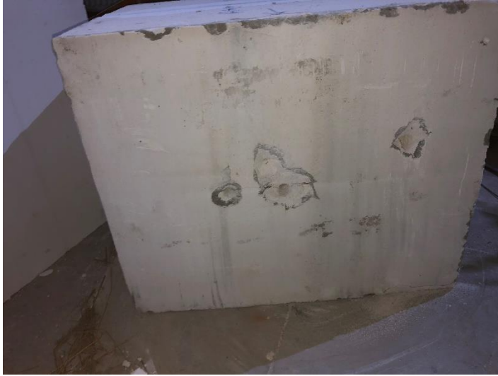
Resim 4.5. Çift sıra oluşturulan gazbetona yapılan atışlar
