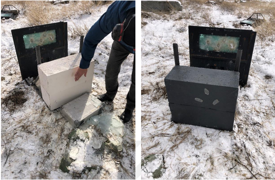
Resim 3.7. Gazbeton duvarın geniş iki kısa yüzeyine yapılacak atışların gösterimi
