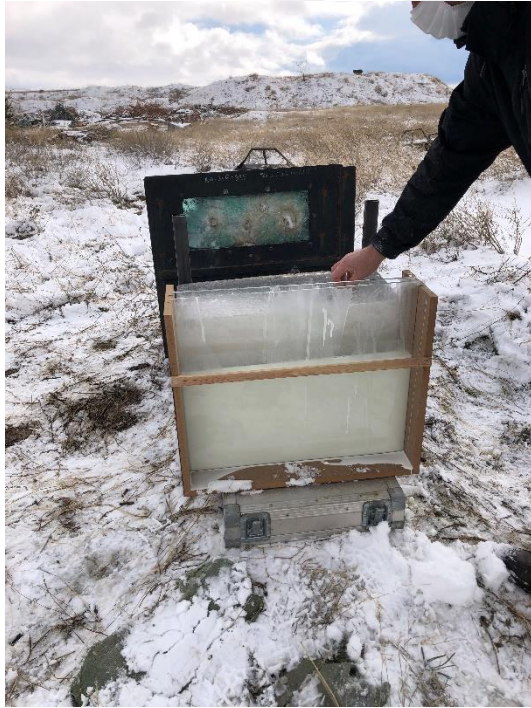
Resim 3.10. Yapıştırma harcı-sıva ve önünde newtonsals olmayan sıvı ile hazırlanmış numune
