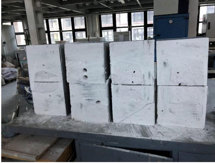
Resim 4.4. Monolitik elastomer poliürea kaplı gazbetonun dar yüzeyine yapılan atışlar
