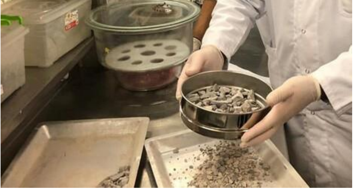
Şekil 16. Eleme işlemi yapılarak ocaktan gelen malzemenin boyutlarına ayrılması
