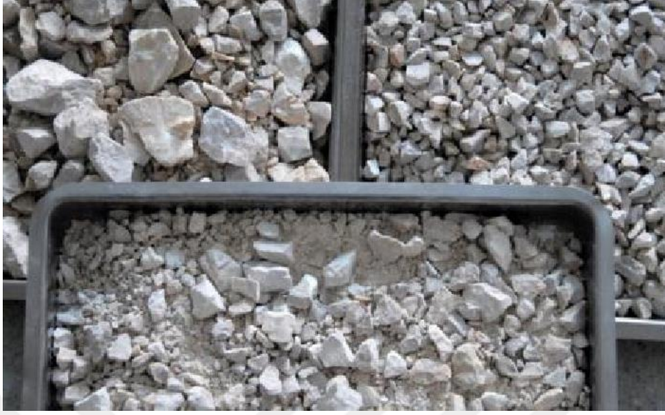
Şekil 17. Malzeme elendikten sonra boyutlarına göre tepsilenmesi
