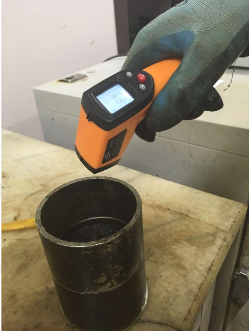
Şekil 22. Lazer Termometre ile sıcaklık değerlerinin belirlenmesi
