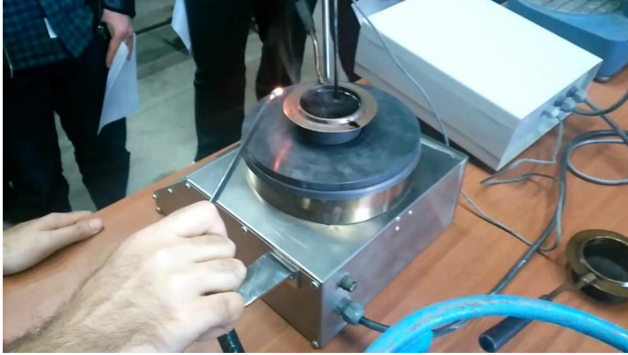
Şekil 9. Parlama Noktası Deneyi
