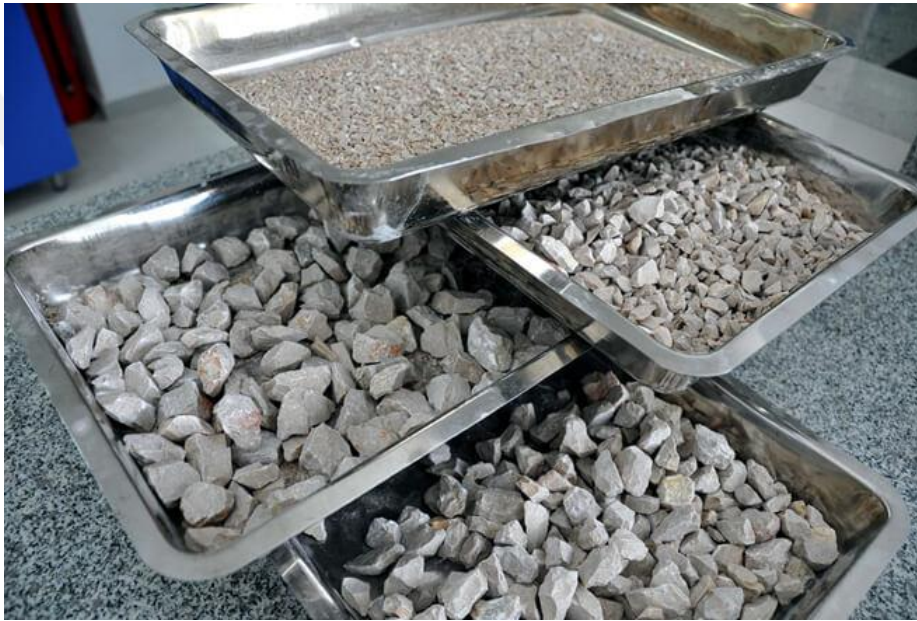
Şekil 10. Elek analizi gerçekleştirildikten sonra boyutlara göre sınıflandırılmış hali
