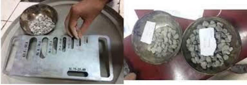
Şekil 15. Yassılık indeksi deneyi deney aparatı ve yapılış anı
