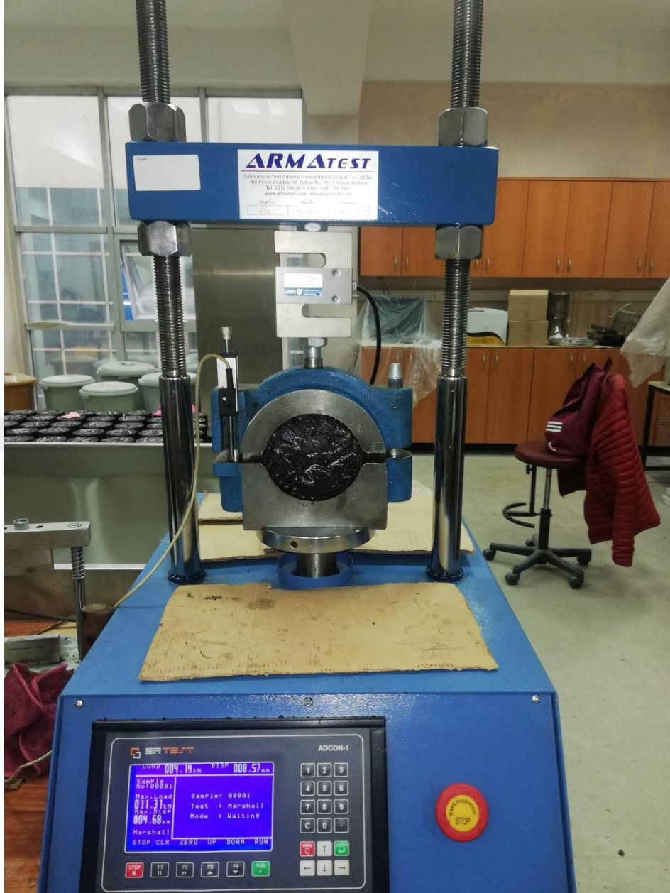
Şekil 24. Marshall Stabilite Test cihazı
