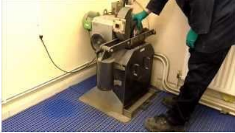
Şekil 13. Cilalanma Deneyi Aleti ve Uygulama Aşaması
