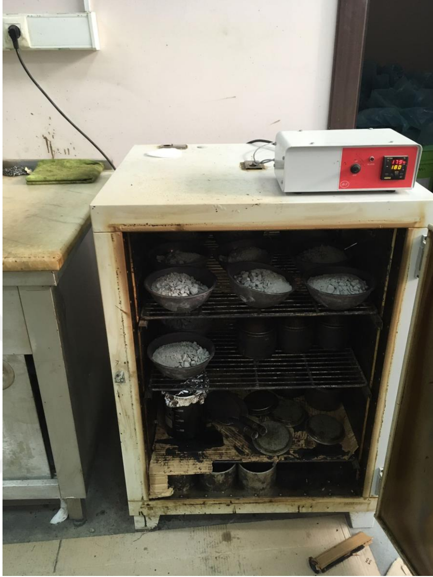
Şekil 19. Etüve konularak 24 saat kurumaya bırakılan numuneler
