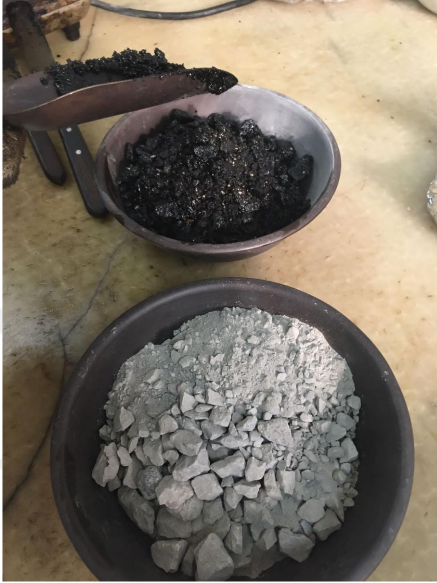
Şekil 21. Bitüm ile karıştırıldıktan sonra sıkışmaya hazır hale gelen numuneler
