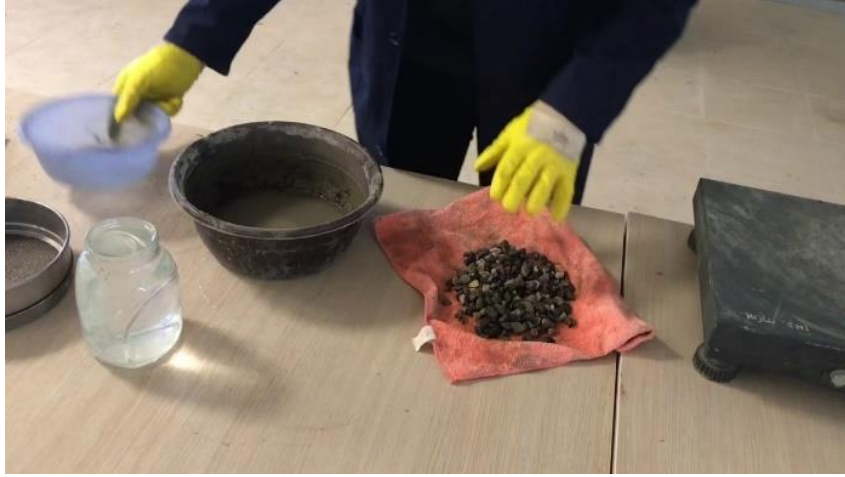
Şekil 14. Özgöl ağırlık ve absorbsiyon deneyi
