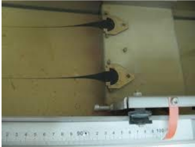
Şekil 7. Düktilite Deneyi; bitümün kopmadan uzayış şekli
