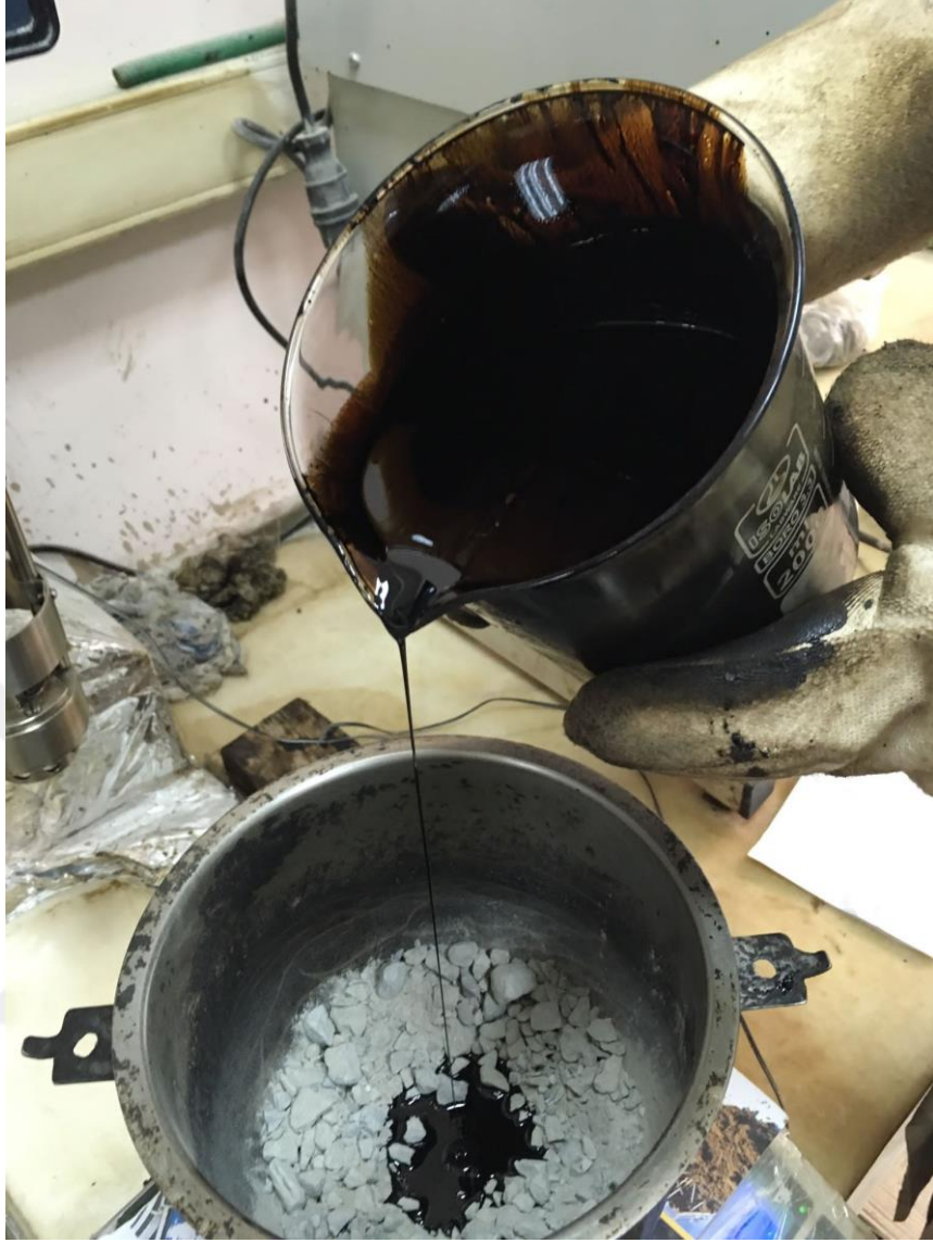
Şekil 20. Bitüm içeriği tartı üzerindeki sıcak agregaya eklenmesi
