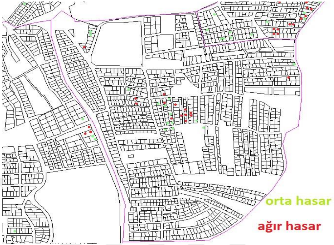
Şekil 3.163. Hızırtepe mahallesi bina hasar durum haritası(Sakarya Büyükşehir Belediyesi 2021).
