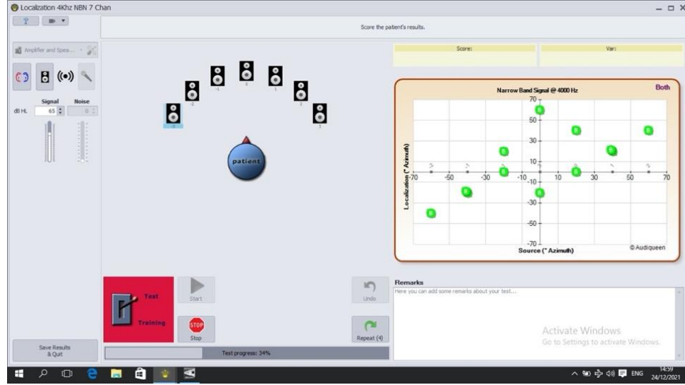
Şekil 3.2. Azimut Lokalizasyon Testi Yazılım Ara Yüzü
