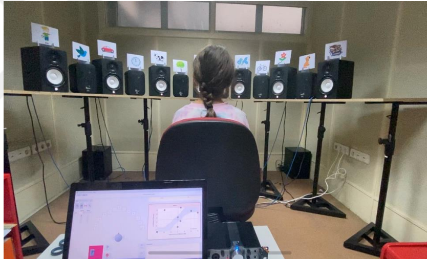
Şekil 3.4. ILD lokalizasyon Test Düzeneği
