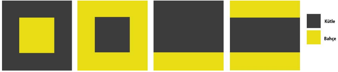
Şekil 5.1. Kütüphane ve bahçe ilişkisi soldan sağa: geleneksel Antakya evi; Ak-İş Konutları ve Yüz Evler 5, 6, 7, 8, 9, 10, 11, 12 numaralı konutlar; Yüz Evler 1,2,3 numaralı konutlar; Yüz Evler 4 numaralı konut
