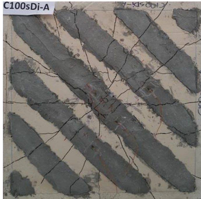
Şekil 4.77. C100sDi-A numunesinin deney sonrası çatlak dağılımı
