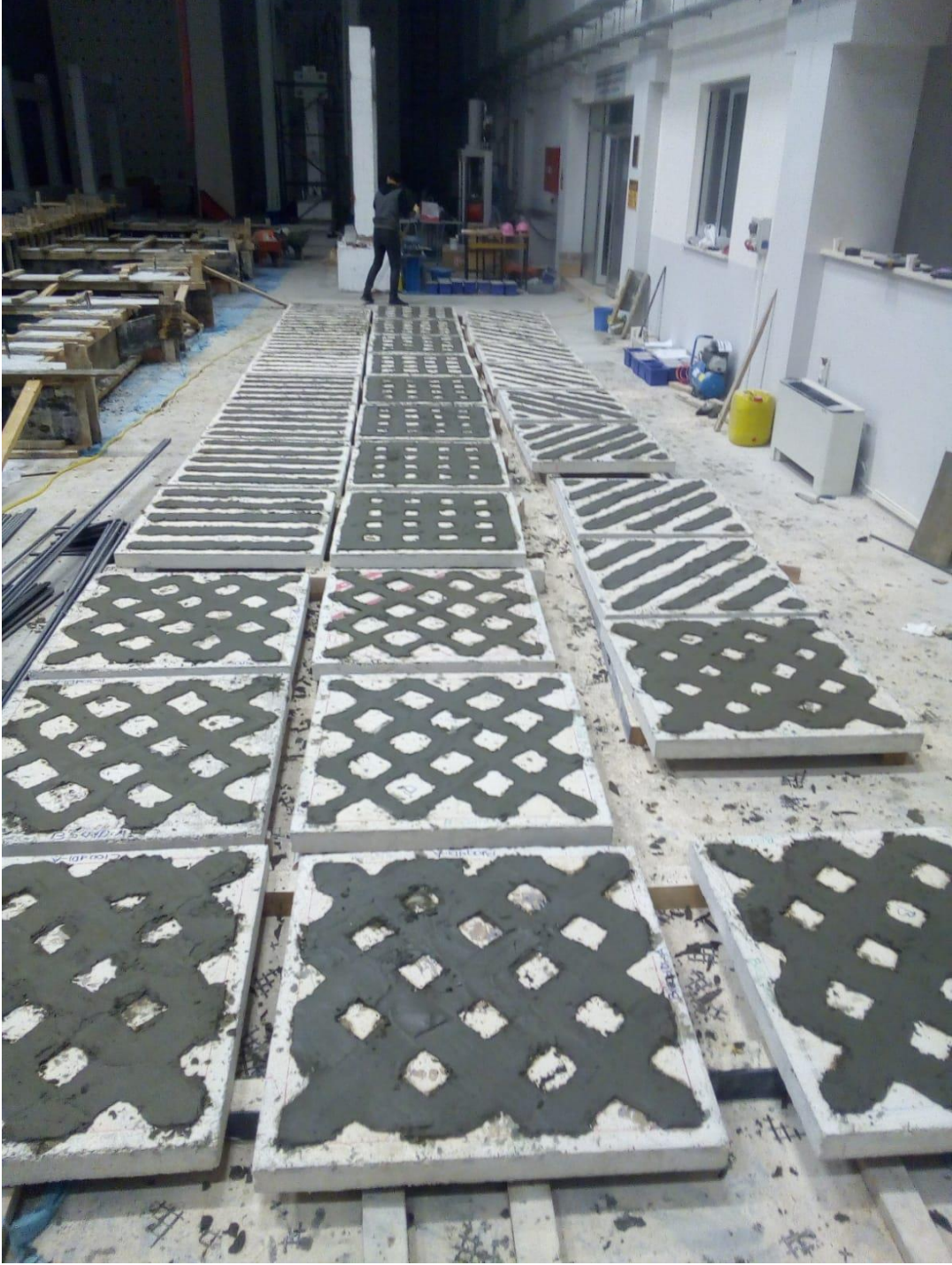
Şekil 3.28. Döşeme elemanların TRM ile güçlendirilmesi
