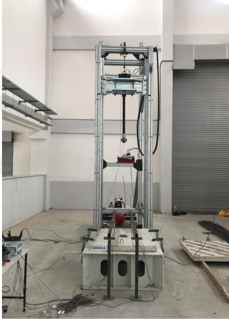
Şekil 3.30. Betonarme döşemelerin deneye hazır hale getirilmesi
