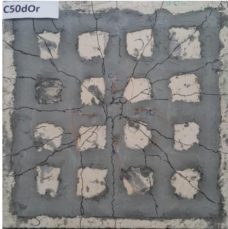
Şekil 4.12. C50dOr numunesinin deney sonrası çatlak dağılımı
