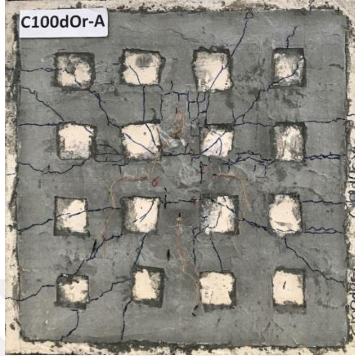
Şekil 4.72. C100dOr-A numunesinin deney sonrası çatlak dağılımı
