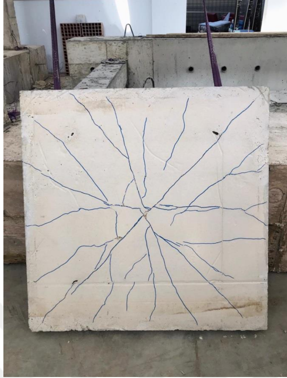
Şekil 4.3. Referans numunesinin deney sonrası çatlak dağılımı
