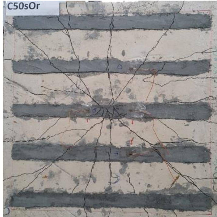
Şekil 4.7. C50sOr numunesinin deney sonrası çatlak dağılımı
