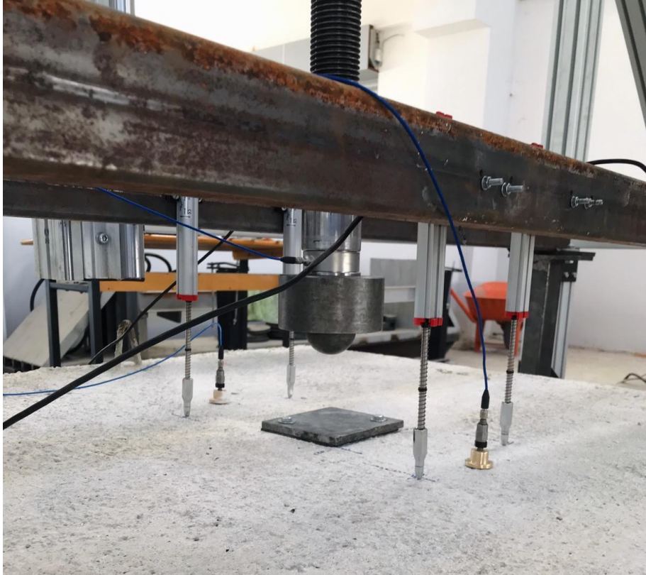
Şekil 3.5. Piriç ve ivmeölçer montajı
