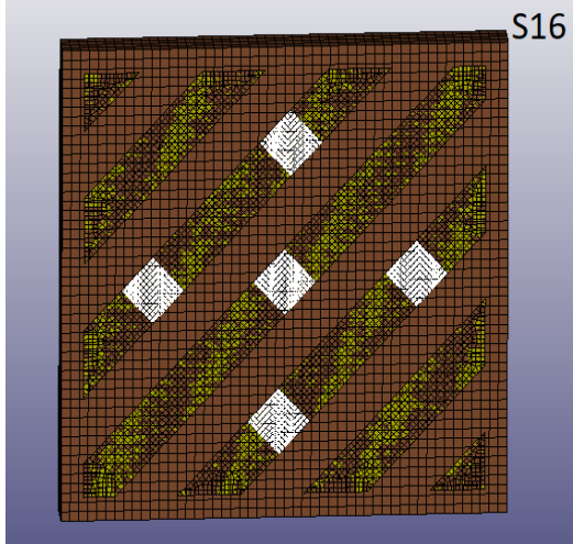
Şekil 3.56. Bütün TRM şeritli betonarme döşemelerin gösterimi
