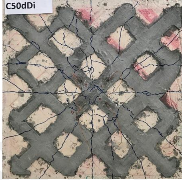
Şekil 4.22. C50dDi numunesinin deney sonrası çatlak dağılımı
