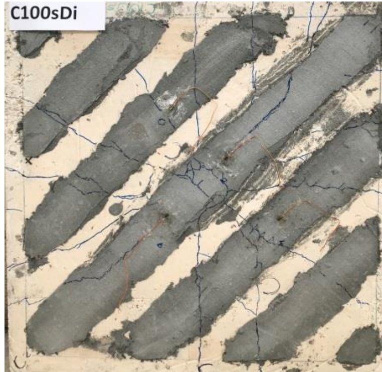
Şekil 4.37. C100sDi numunesinin deney sonrası çatlak dağılımı
