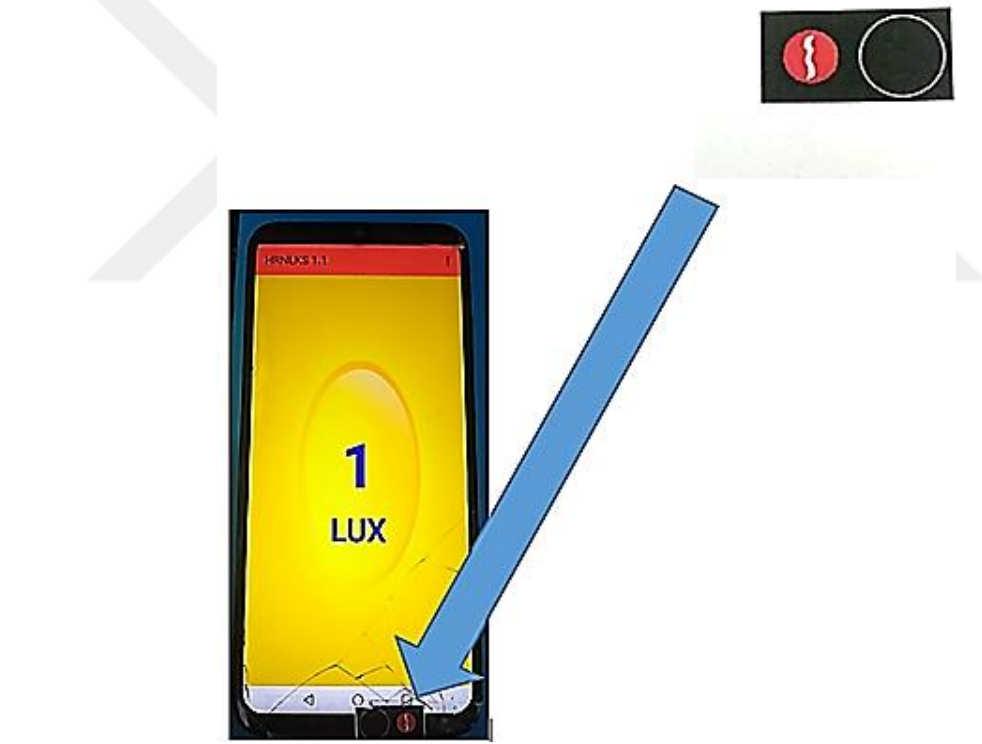
Şekil 3.6. Akıllı telefonun ışık sensörünün üzerine difüzörün yerleştirilmesi
