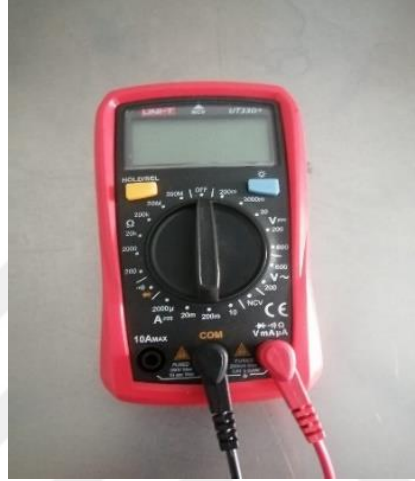
Şekil 3.9. LDR'nin direnç değişimlerini okumak için kullanılan multimetre
