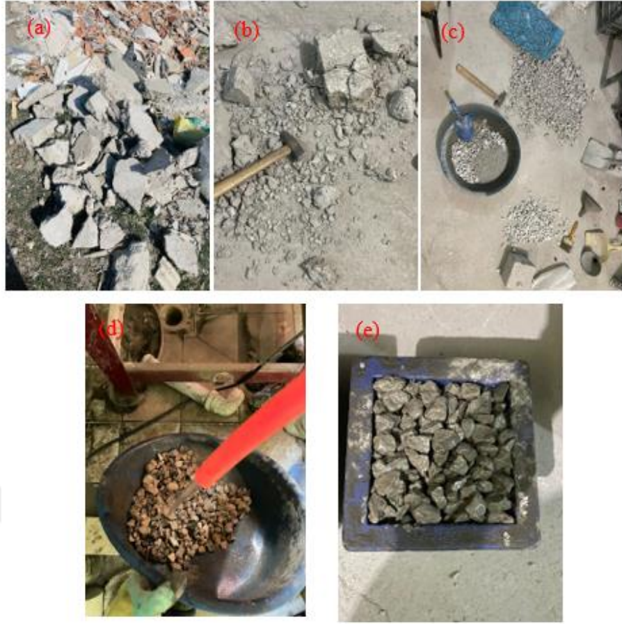
Şekil 15. (a) İnşaat yıkıntısı (b) ve (c) geri dönüşüm agrega temini (d) agregaların yıkanması (e) geçirimli beton dökümü
