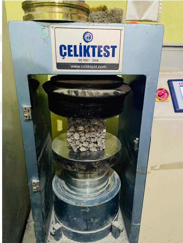
Şekil 23. Örnek olarak %100 geri dönüşüm agregası ile üretilmiş numunenin basınç testi
