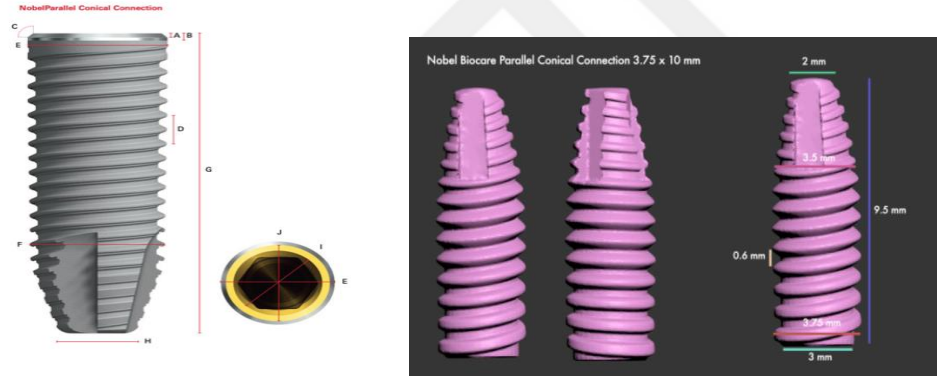
Şekil 3.10. Araştırmada kullanılan maksiller sağ 1.premolar diş için titanyum implant materyal morfolojisi görselleri; l: implant uzunluğu-10 mm, implant çapı- 3.75 mm, p: yiv adımı-0,6 mm, t:yiv derinliği-0,2 mm. Nobel Biocare Parallel Conical Connection® (PCC) 3.75 x 10 mm - bone level
