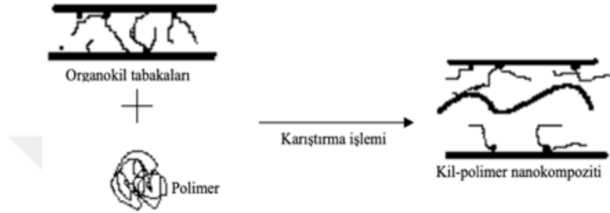
Şekil 8. Polimer-kil nanokompozitlerin eritme yöntemi ile sentezi[23].
