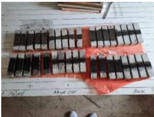
Şekil 3.8. Karbon ve cam elyaf numunelere yapıştırıldıktan sonra görünümü
