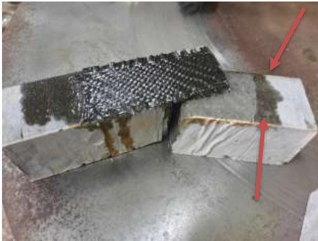
Şekil 3.12. YD numunesinin pürüzsüz yüzeyinden karbon elyaf sıyrılması
