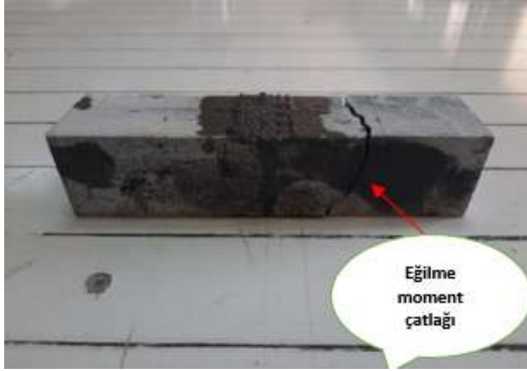
Şekil 4.17. Yüksek dayanımlı 1/7 (AO) karbon elyaf takviyeli kumaş numune
