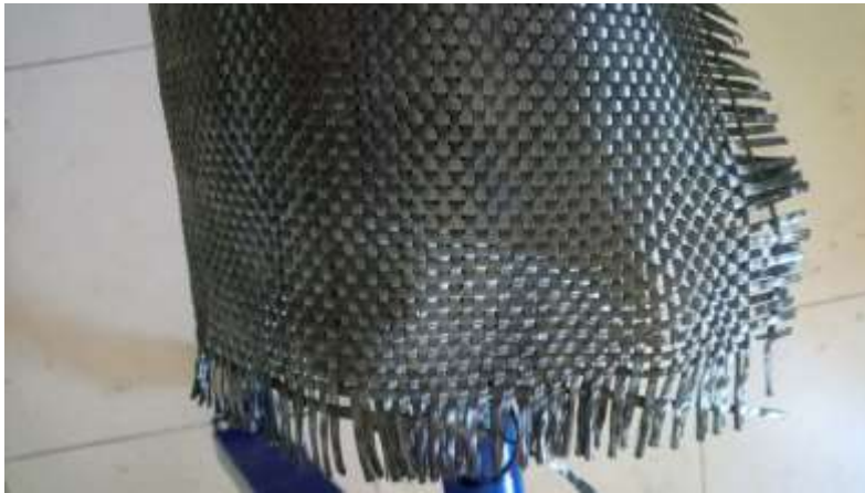
Şekil 3.3. Karbon elyaf kumaş örneği
