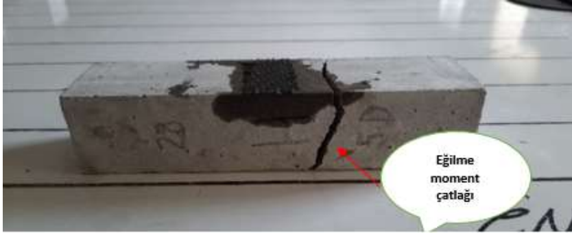
Şekil 4.10. Orta dayanımlı 1/7 (AO) karbon elyaf takviyeli kumaş numune
