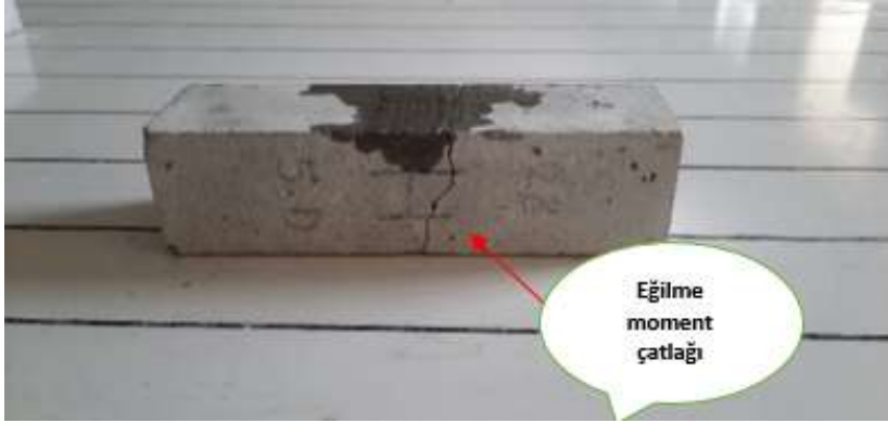
Şekil 4.13. Orta dayanımlı 1/7 (AO) cam elyaf takviyeli kumaş numune
