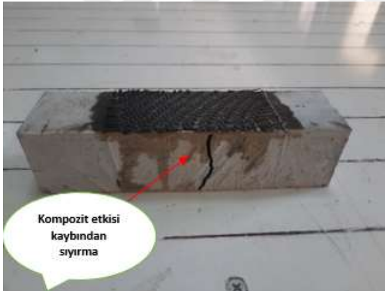
Şekil 4.18. Yüksek dayanımlı 4/7 (AO) karbon elyaf takviyeli kumaş numune
