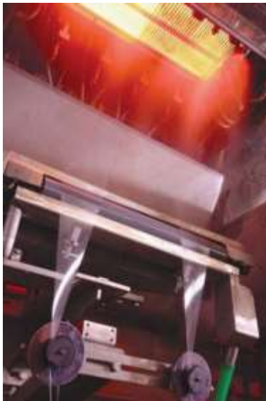
Şekil 2.5. Yüksek sıcaklıktaki sıvı cam elyafı (Kompozit, 2021)
