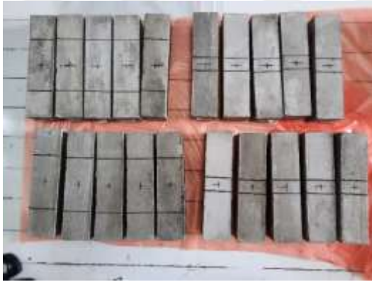
Şekil 3.7. Yapıştırılma işlemine hazır numuneler
