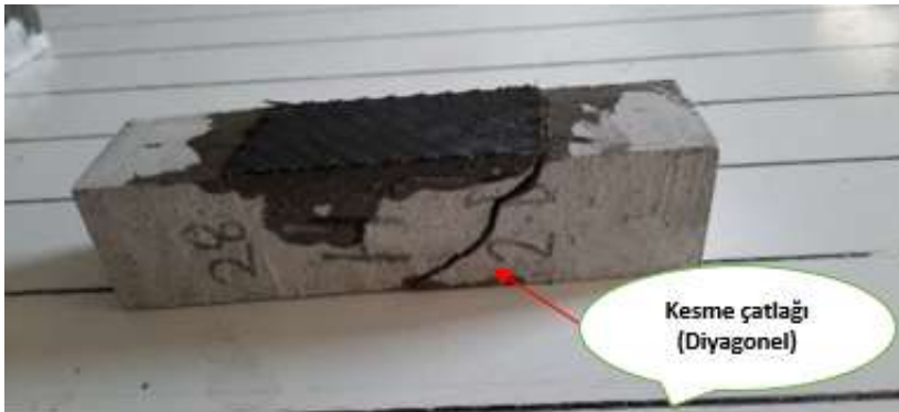
Şekil 4.11. Orta dayanımlı 4/7 (AO) karbon elyaf takviyeli kumaş numune
