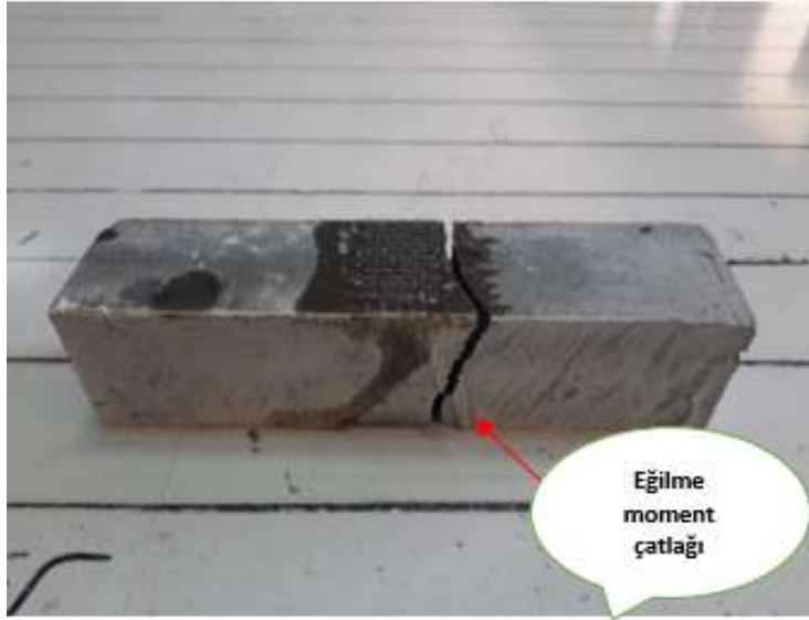
Şekil 4.20. Yüksek dayanımlı 1/7 (AO) cam elyafı numune
