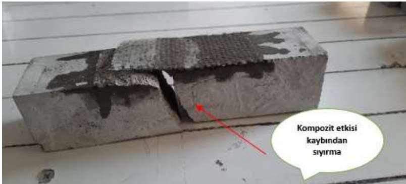
Şekil 4.14. Orta dayanımlı 4/7 (AO) cam elyaf takviyeli kumaş numune
