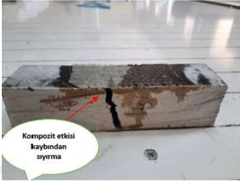
Şekil 4.21. Yüksek dayanımlı 4/7 (AO) cam elyaf takviyeli kumaş numune
