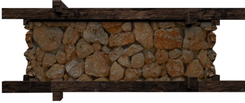
Şekil 49: Dış Duvardaki Hatıl ve Piştuvan Yerleşim Düzeni
