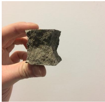
Şekil 3.6 : Tek eksenli basınç deneyinde küp numunelerin kırılma şekli
