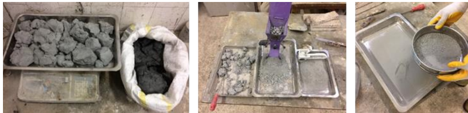
Şekil 3.4 : Filtre kalıntı malzemesinin hazırlanması aşamaları
