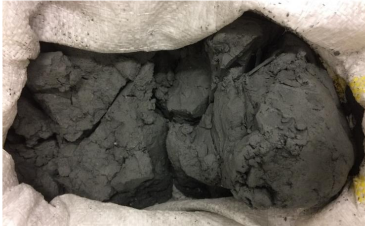
Şekil 3.2 : Hazır beton santralinden alınan filtre kalıntı malzemesi
