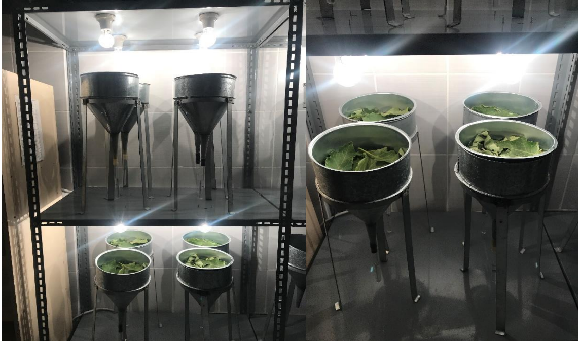
Şekil 3.10 Berlese hunisi kullanılarak akar örneklerinin elde edilmesi
