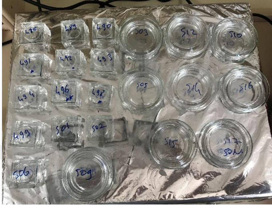
Şekil 3.11 Hot plate üzerindeki sirakus kaplarında laktofenol ile berraklaştırılan akarlar
