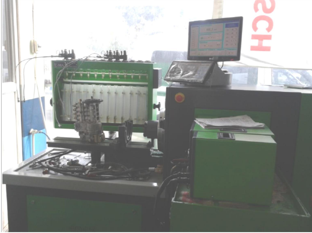
Şekil 3.5. Motor yakıt pompası ve test düzeneği
