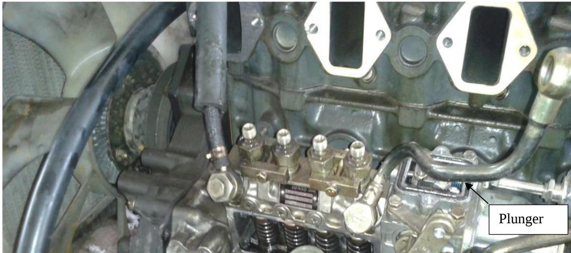
Şekil 3.4. Mekanik yakıt pompası ve plancır görüntüsü
