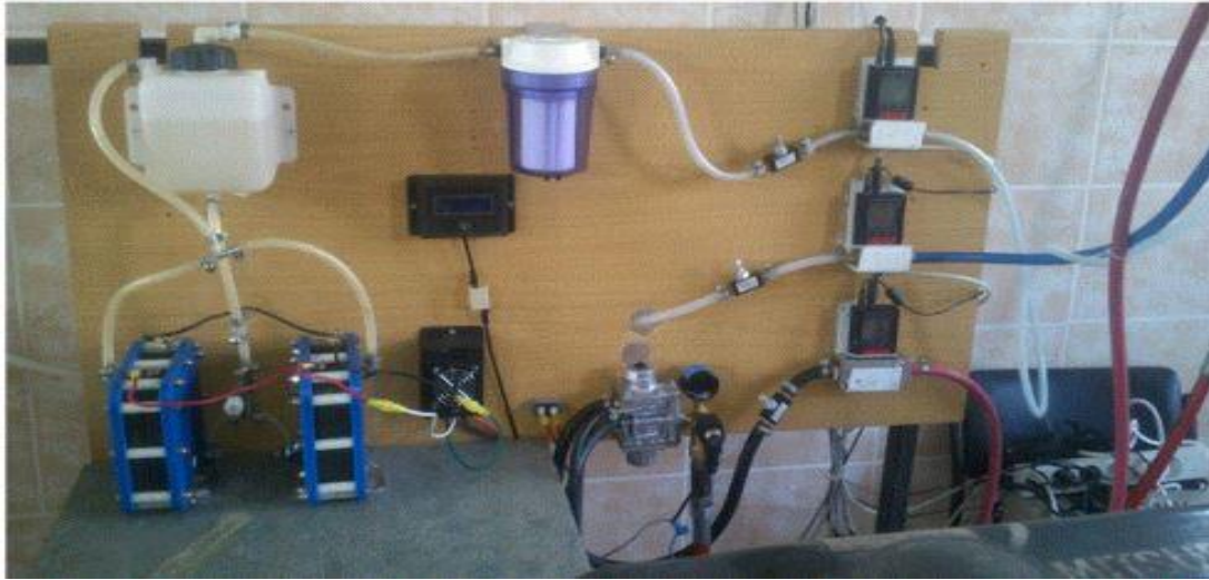
Şekil 3.2 Hidroksi gaz jeneratörü
