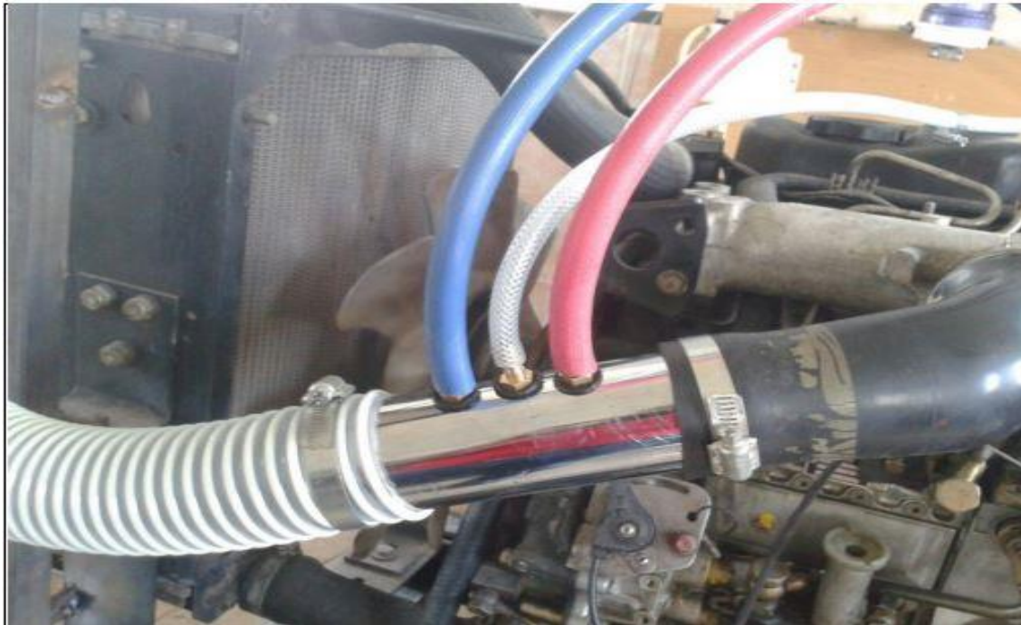
Şekil 3. 3. Emme manifoldu gaz karışım odacığı
