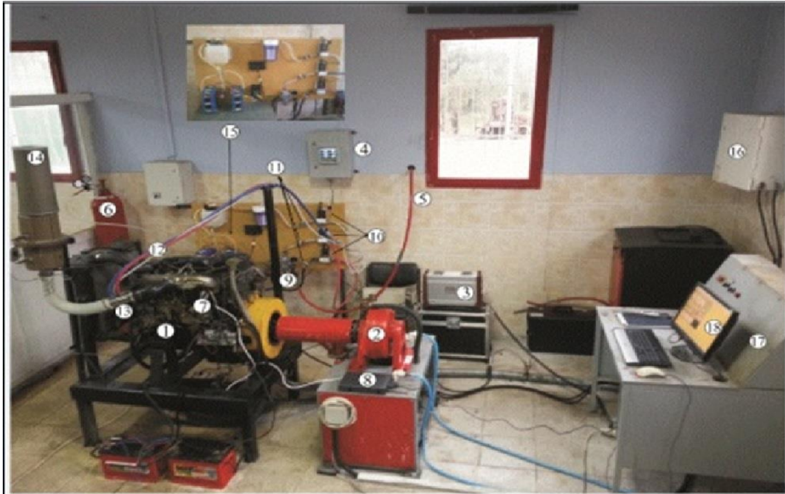
1) Motor 2) Dinamometre 3) Egzoz gazı analizörü 4) Veri kaydedici 5) CNG hattı 6) Hidrojen tankı 7) Yakıt pompası pistonu üzerinde step motor 8) Step motor sürücüsü 9) CNG regülatörü 10) Gaz debimetreleri 11) İğne kanatları 12) Gaz yakıt hatları 13) Karışım haznesi 14) Hava filtresi 15) HHO sistemi 16) Sıvı Yakıt Debimetresi 17) Dinamometre Kontrol Ünitesi 18) Ana Bilgisayar
