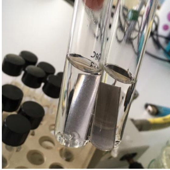
Şekil 4.3. Çelik kuponların cam boncuklu serum fizyolojik içeren tüplere aktarılması
