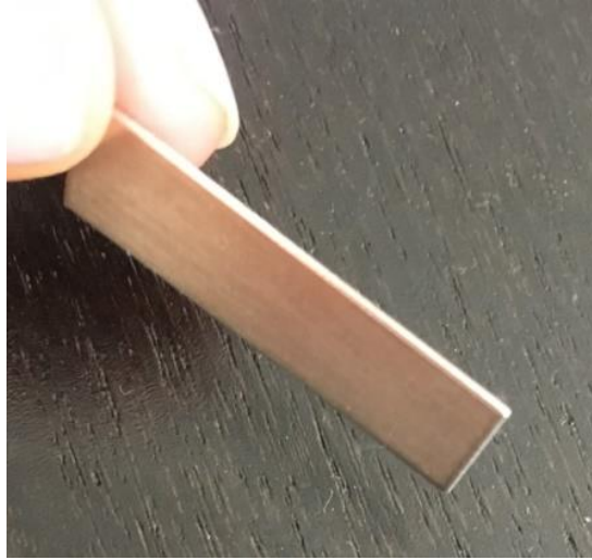
Şekil 4.2.. Tez çalışmasında kullanılan paslanmaz çelik kupon (uzunluk 2,5 cm, genişlik 0,8 cm ve yükseklik 0,1 cm)
