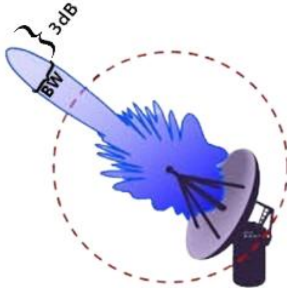
Şekil 2.1.2 Anten huzmesi ve 3dB huzme genişliği (BW).
