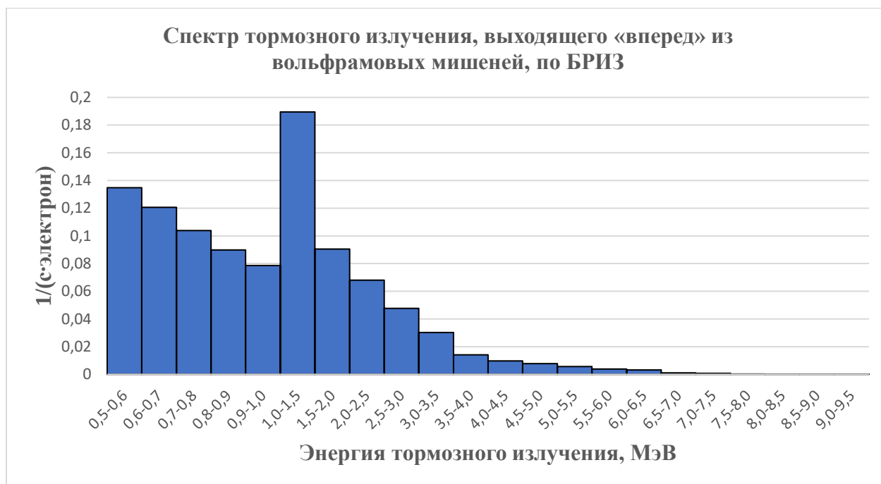
Рис 8.2.3- Доля тормозного излучения, выходящего «вперед» из вольфрамовых мишеней, по БРИЗ
