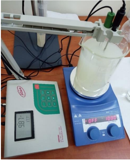
Şekil 18. TEMPO/NaClO/NaBr sistemiyle oksidasyon işlemi
