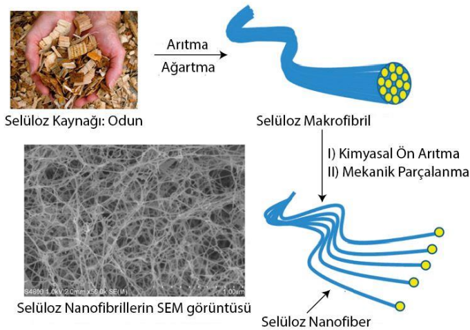
Şekil 5. Kimyasal ve mekanik işlem kombinasyonu ile selüloz nanolif üretimi (Chakrabarty ve Teramoto, 2018).
