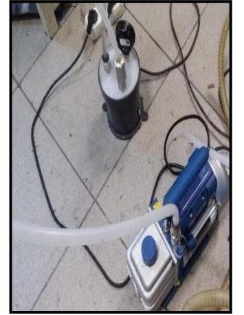
Şekil 3.19. Reçine hattının kapatılarak vakumlama işleminin yapılması.
