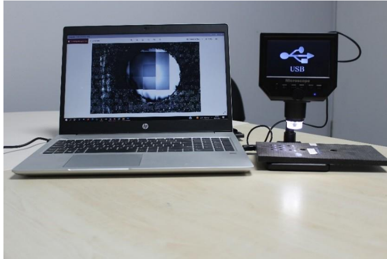
Şekil 3.39. Delik görüntüsünün dijital mikroskop ile alınması.
