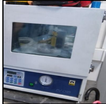
Şekil 3.12. Çözeltinin vakum fırınında gazdan arındırılması.
