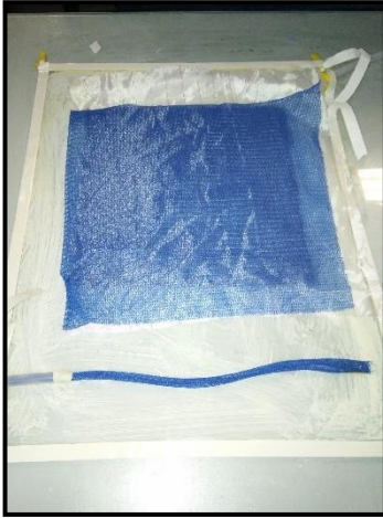
Şekil 3.17. Reçine ve vakum hattının yerleştirilmesi.
