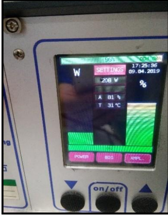
Şekil 3.8. Genliğin % 80'de, sıcaklığın 31 C°'de sabit tutulması.
