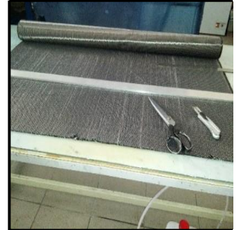
Şekil 3.13. NCF CF kumaşın kesilmesi.
