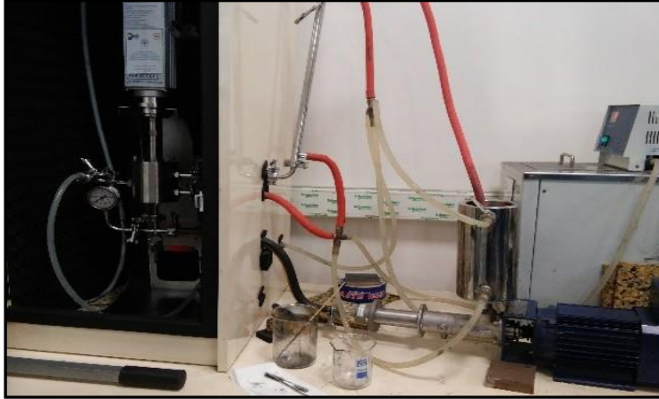
Şekil 3.6. Etanol, MWCNT, sürfaktanın geri dönüşüm tankına boşaltılarak soğutmalı akış hücresi içerisinde sonotrod ile karıştırılması.
