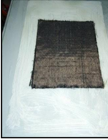
Şekil 3.14. Kalıp ayırıcının sürülmesi.
