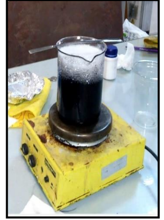
Şekil 3.10. 80 C ° de solventin (Etanol) buharlaştırma.
