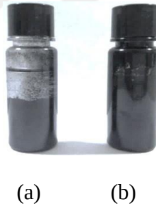
Şekil 4.1. MWCNT dispersiyonu, a) Süre 1 saat b) Süre 10 saat.
