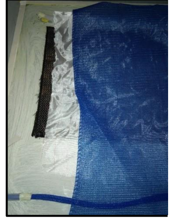
Şekil 3.16. Sıyırma kumaşı ve reçine akış filesinin serilmesi.
