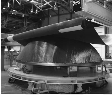
Şekil 1.6. Airbus A380 arka basınç bölme üretiminde NCF kumaşın serilmesi.
