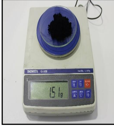
Şekil 3.4. MWCNT miktarının hesaplanarak tartılması.
