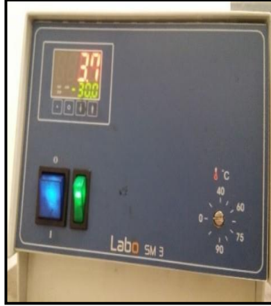
Şekil 3.9. Soğutma tankı içerisindeki su sıcaklığı -30 C°.
