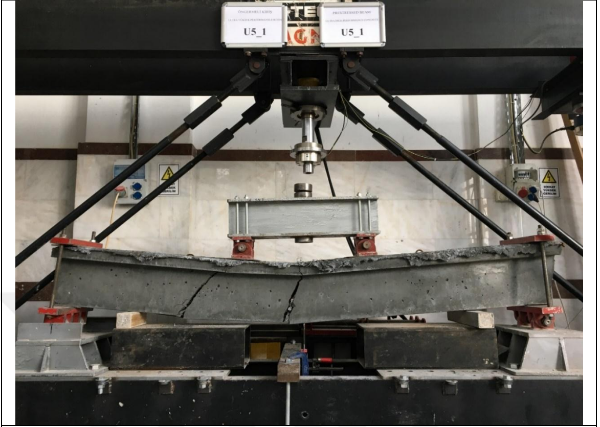
U5-120 kirişinin deney sonu görünümü
