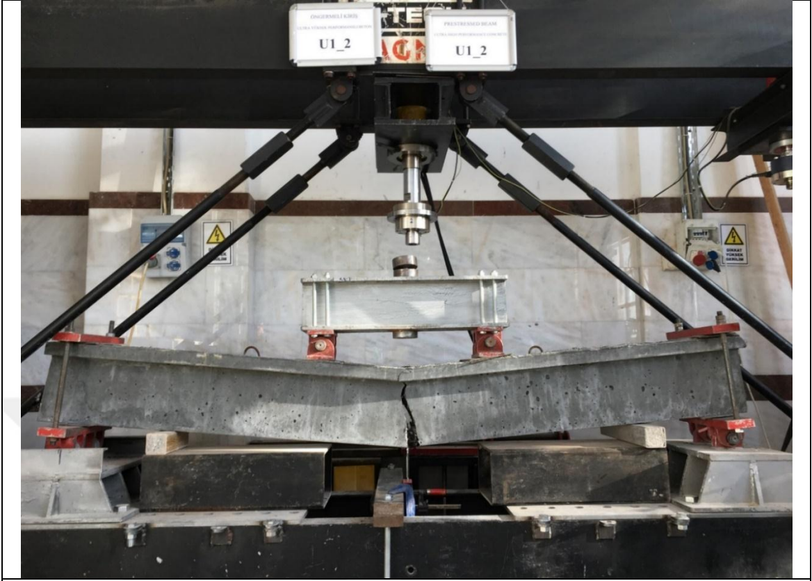
U1-15 kirişinin deney sonu görünümü
