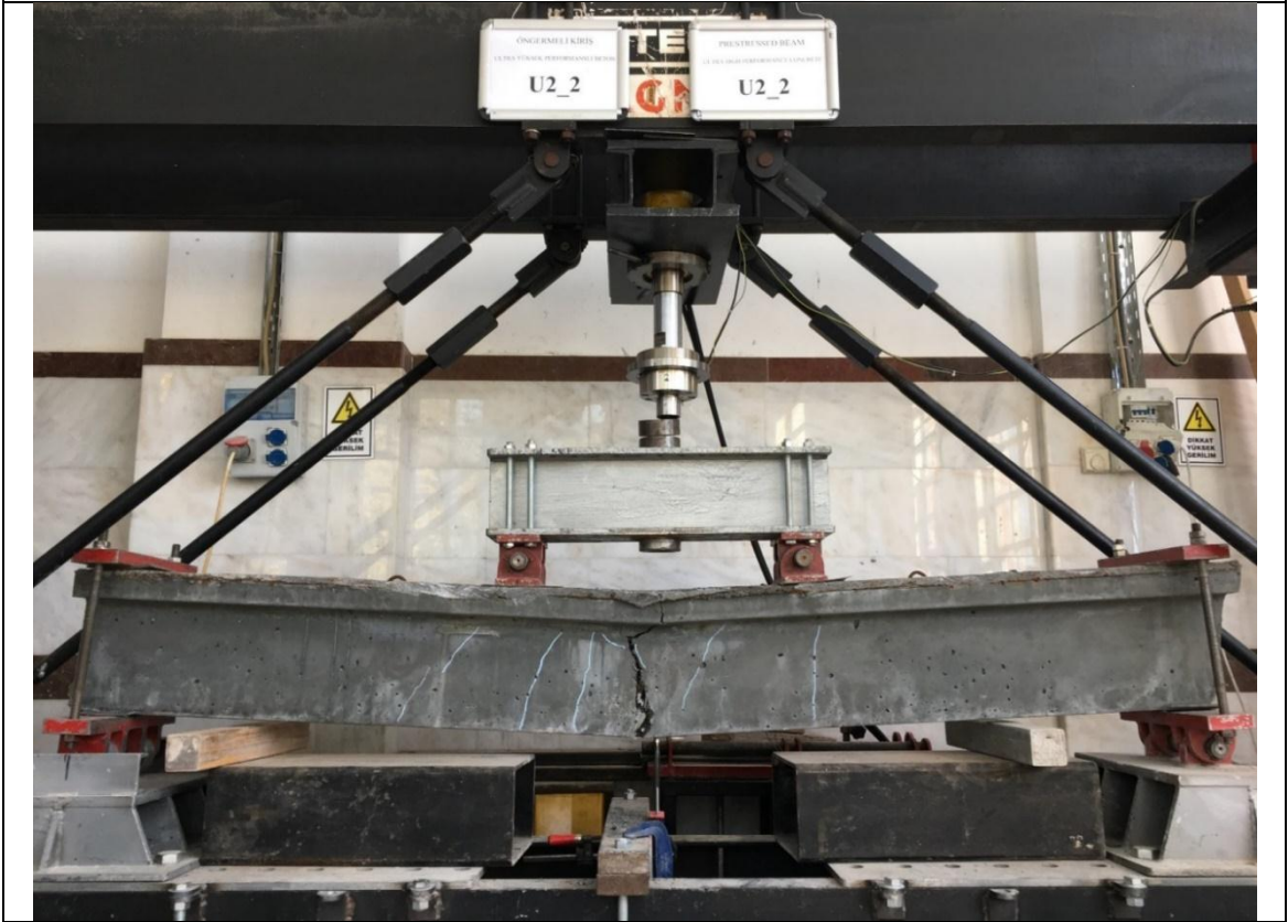
U2-30 kirişinin deney sonu görünümü
