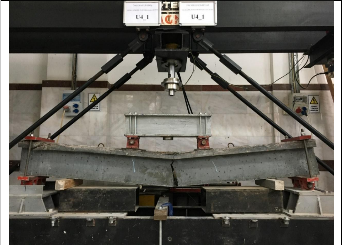
U4-120 kirişinin deney sonu görünümü
