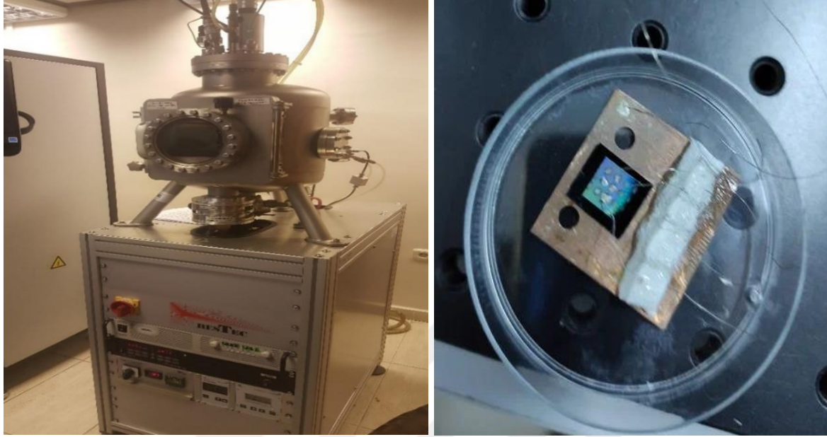
Resim 5.4. a) Termal buharlaştırma sistemi ve b) Al/3D-Gr/lazer desenli p-Si/Al Schottky diyot
