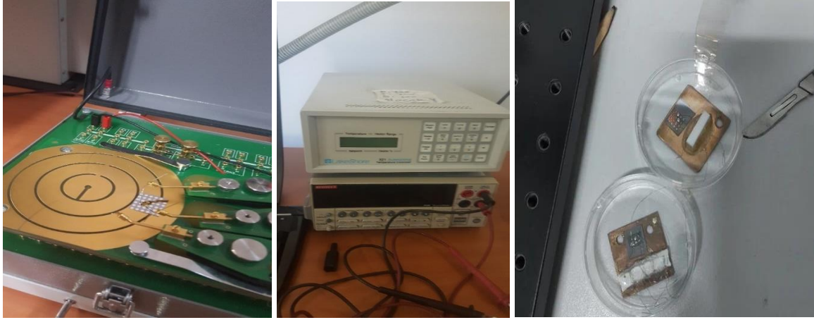
Resim 5.8. a) İki nokta prob I-V ölçümü b) Keithley 4200 akım-gerilim kaynağı c) Al/3D - Gr/ LP p-Si/Al Schottky diyot
