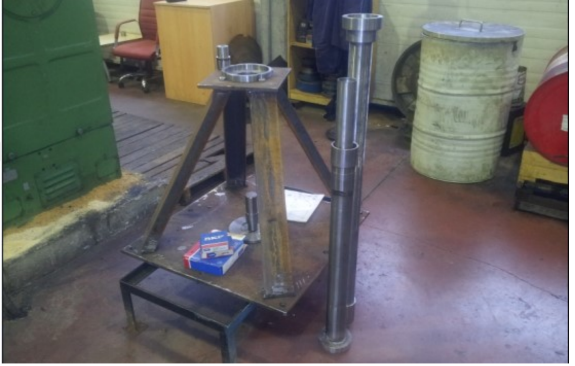
Şekil 3.108. Güneş-Rüzgâr Hibrit Türbininin İmalatı Tamamlanan Destek Ayağı ve Mili.
