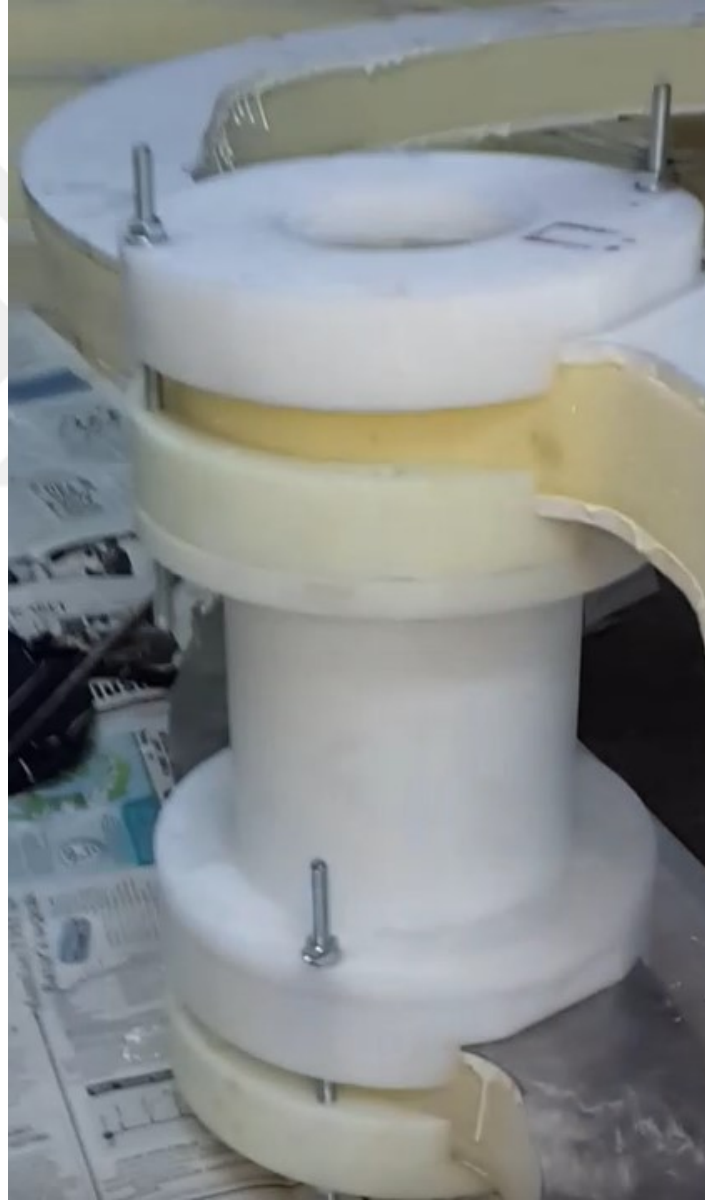
Şekil 3.112. Güneş-Rüzgâr Hibrit Türbini Kanat Göbek Geçme Şeklindeki Montaj Görünümü.
