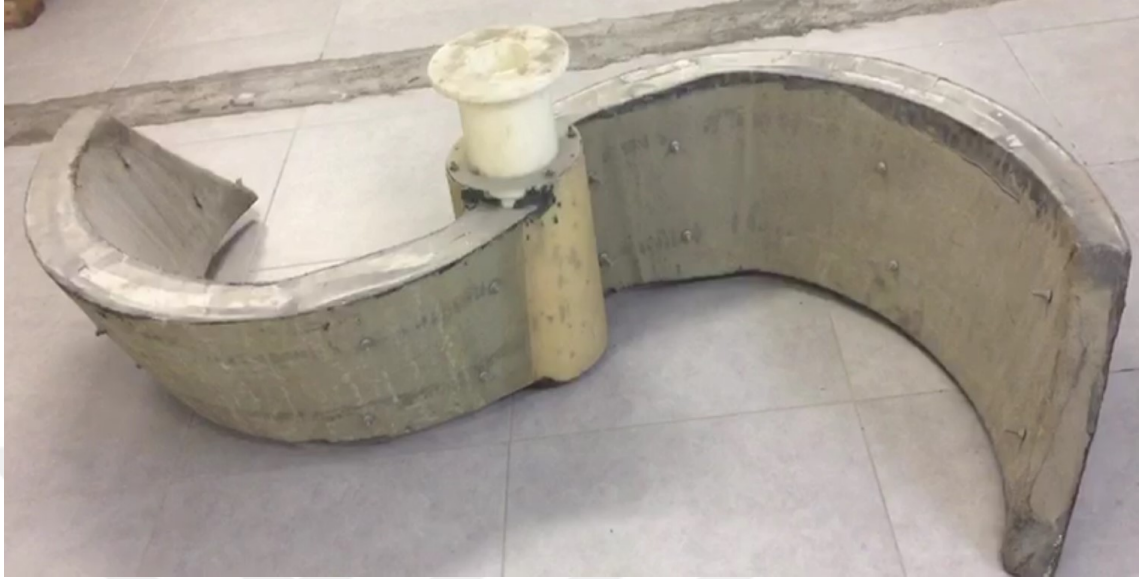
Şekil 3.113. Güneş-Rüzgâr Hibrit Türbini Dış Kabuğu Fiberglastan Yapılmış Örnek Kısmi Kanat İmalatı.
