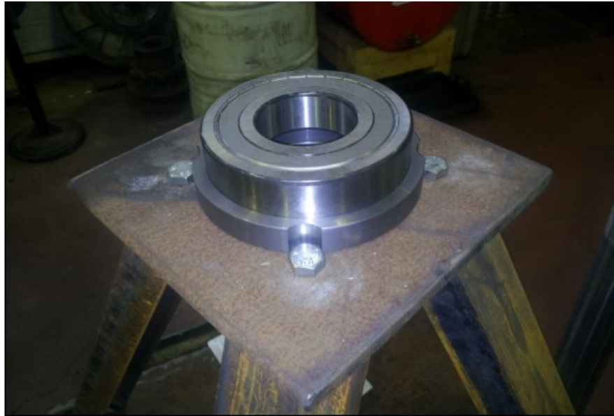
Şekil 3.109. Destek Ayağı Dış Rulman Bağlantısı Yakından Görünümü.
