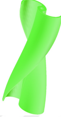
Şekil 3.101. Rüzgâr Trübini Kısmı İskelet Yapısının Poliüretanla Kabuklanmış Görüntüsü.
