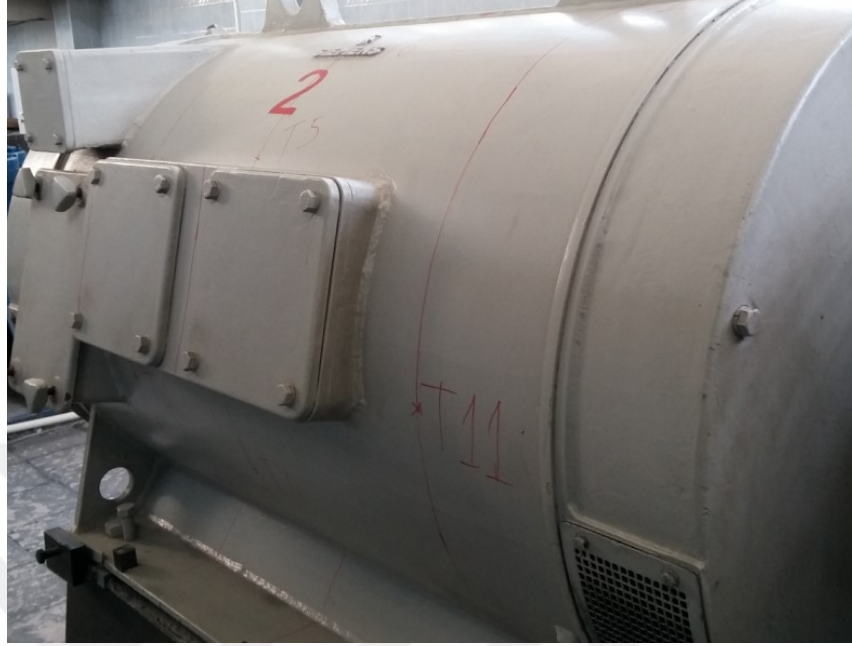
Şekil 3.46. Motor Üzerinde İşaretlenen Sıcaklık Ölçüm Noktaları.
