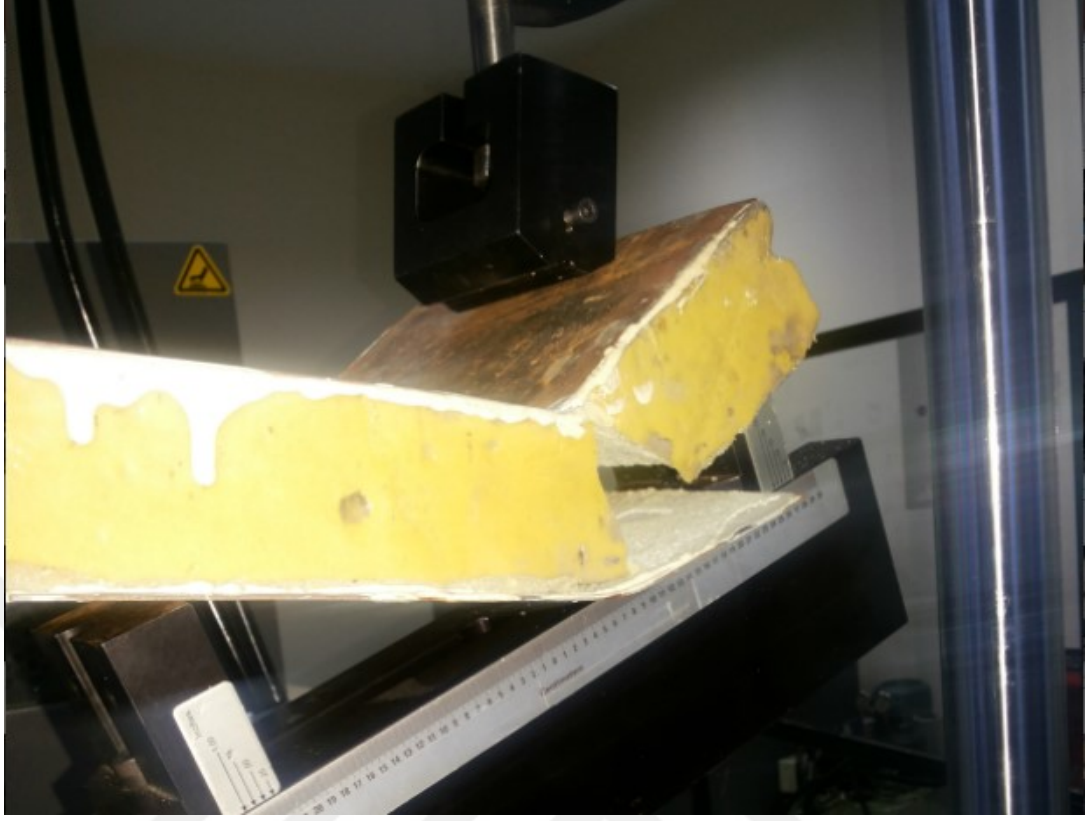
Şekil 3.85. Test Sonucu Deforme Olan Test Numunesi-1.
