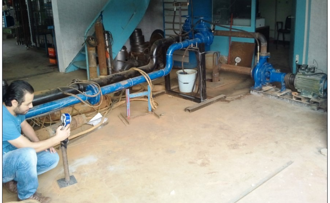
Şekil 3.21. Motopomp Test Düzeneğinde Termal Kamera ile Sıcaklık Ölçümü.
