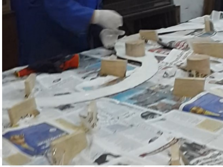
Şekil 3.103. Sandviç Kanat Bileşenlerinin Yapıştırılması İçin Yapılan Ahşap Aparatların Görüntüsü.
