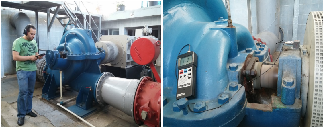
Şekil 3.52. Ölçüm İçin Sabitlenen Metal Küpler Üzerinden Titreřim Ölçümleri.
