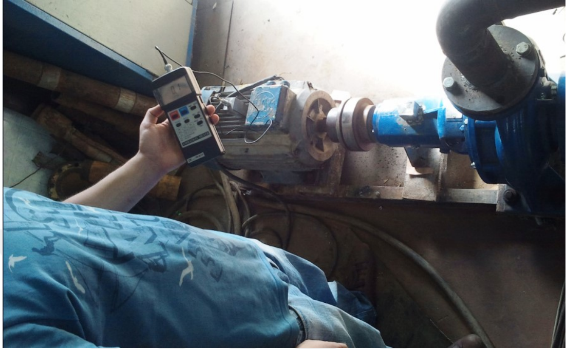
Şekil 3.22. Motopomp Test Düzenğinde Titreşim Ölçümü.
