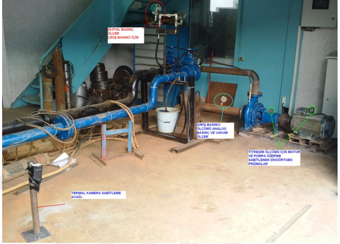
Şekil 3.20. Deneysel Motopomp Test Düzeneği.
