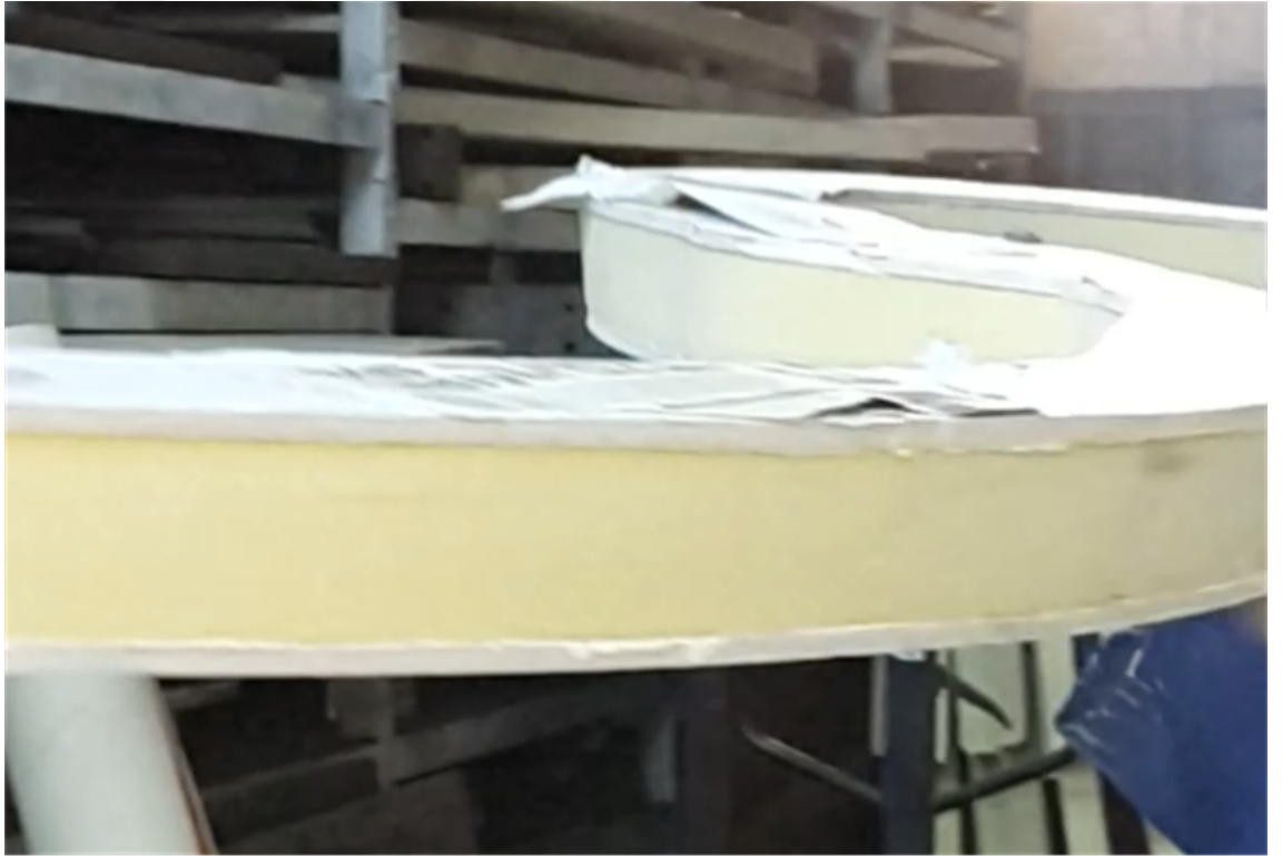
Şekil 3.104. Elde Edilen PVC Arası Poliüretan Sandvic Kompozit Kanat Profili.
