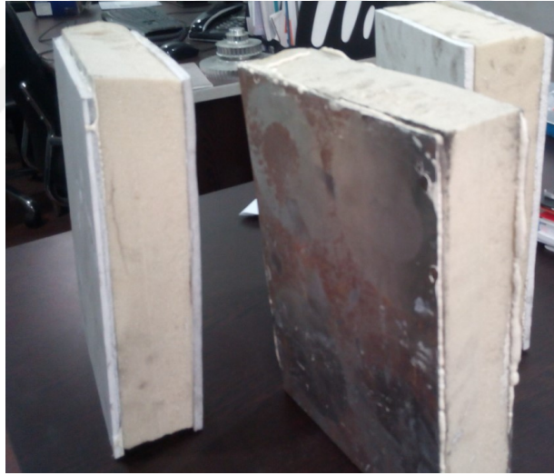
Şekil 3.83. Hazırlanan Sandviç Panel Malzeme Test Numuneleri.
