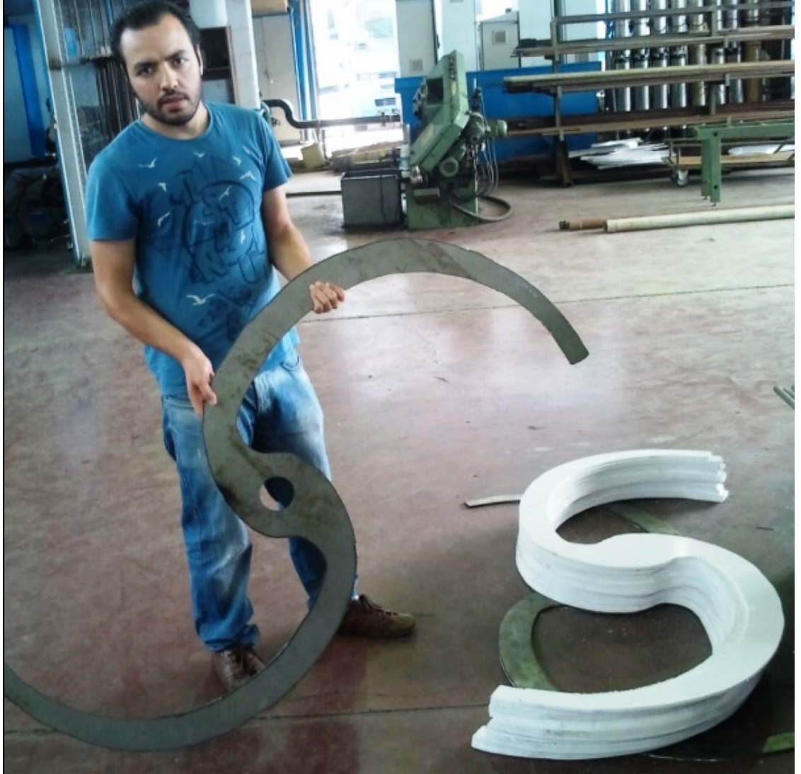
Şekil 3.111. İmalat Aşamasındaki Rüzgâr Türbin Kanat İskeleti Parçaları.
