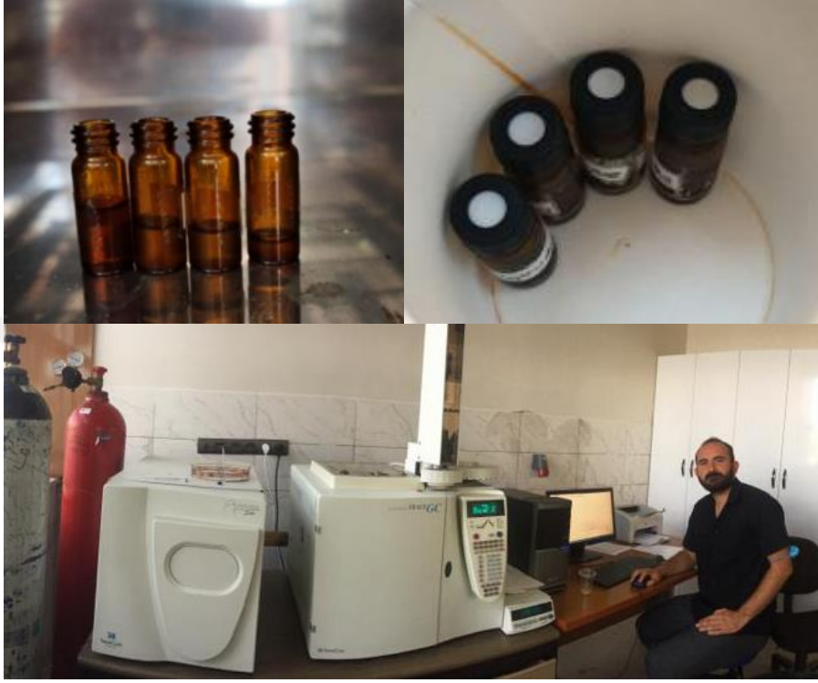
Şekil 3.19. Yağ asitleri tayini için tüplerden hekzanın ayrılması ve türevlendirme işlemi
