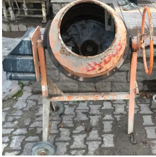
Şekil 3.2. Beton numunelerinin üretiminde kullanılan betoniyer.
