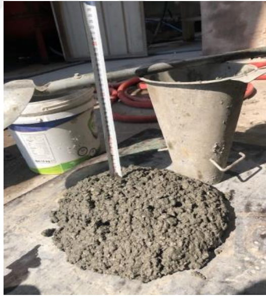
Şekil 3.6. P3bll beton serisi çökme deneyi.
