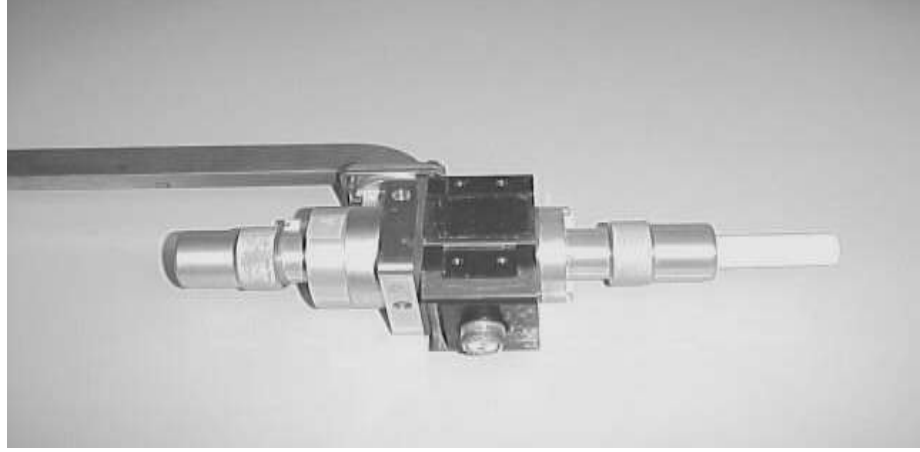
Şekil 3.5 Numune tutucu ve boşluk sistemi.
