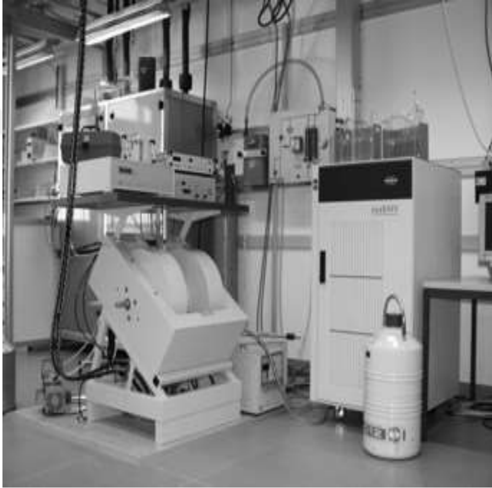
Şekil 3.2 ANAEM' de bulunan, X-Bandında, çalışma frekansı 9-10 GHz, sıcaklık aralığı 125-500 K olan bir spektrometre.
