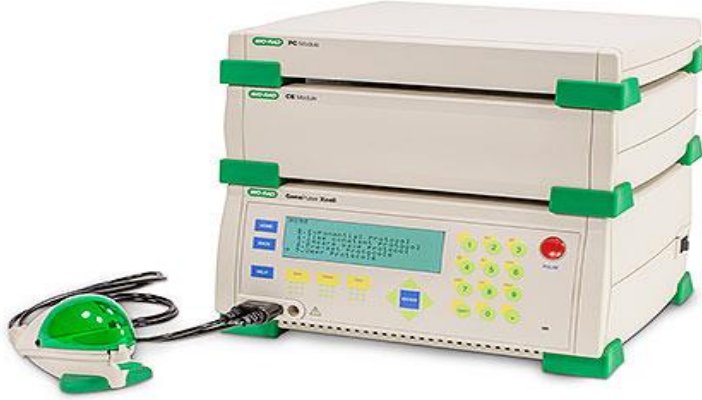
Şekil 3.1. Gene Pulser Xcell modül elektroporasyon sistemleri, ana bölmeyi, iki aksesuar modülünü ve ShockPod™ kuvvet kamerasını içerir
