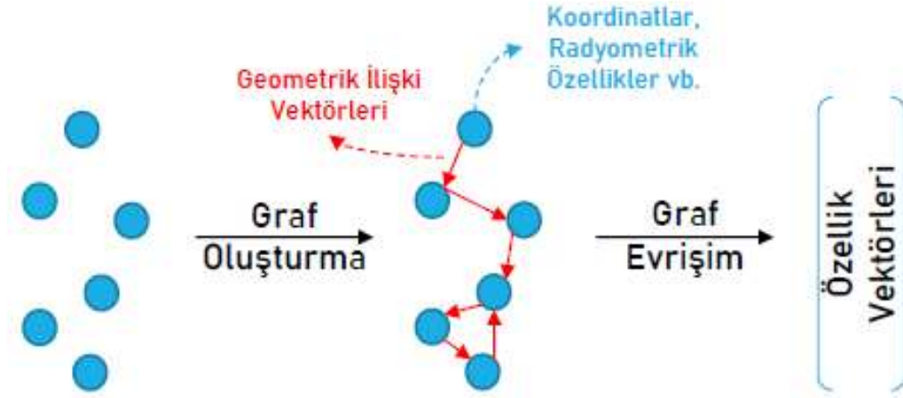
Şekil 3.14 : Graf evrişim temelli yöntemlerin örnek işlem akışı şeması.
