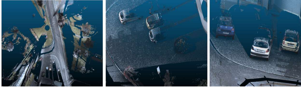
Şekil 3.1 : 3B nokta bulutlarında veri üretim koşullarından kaynaklı noksanlıklar.
