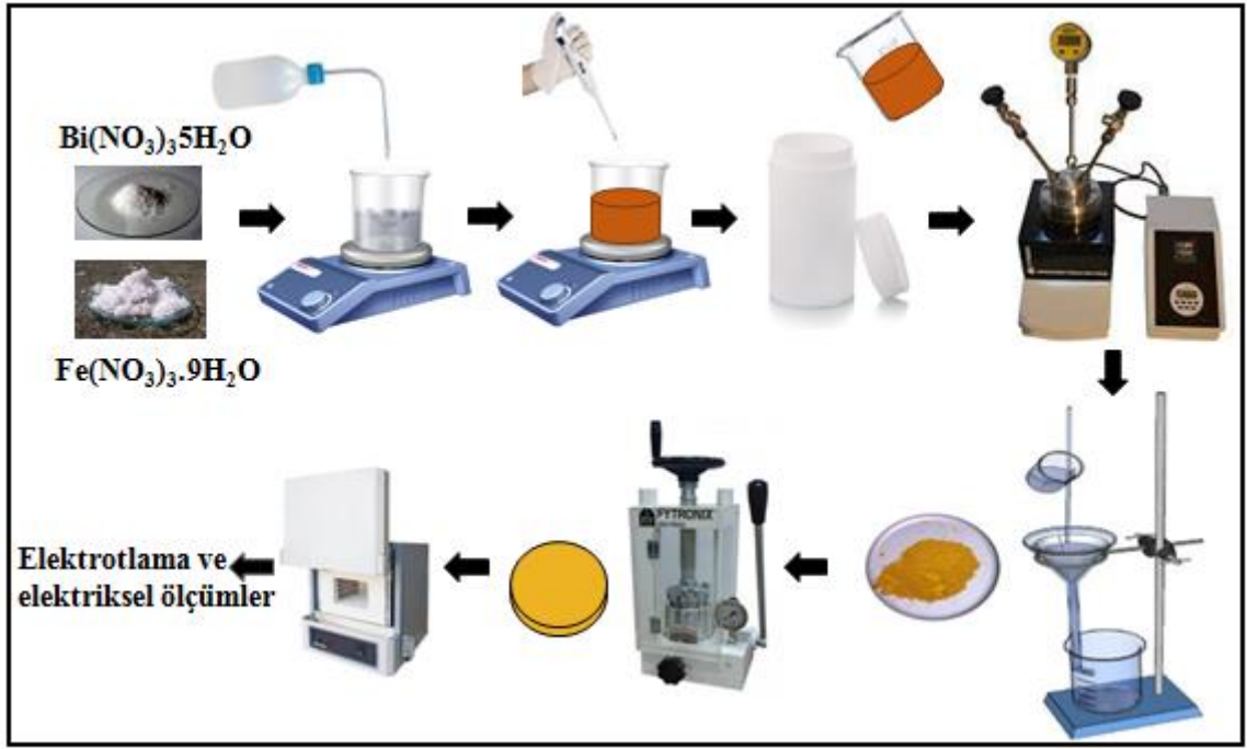
Şekil 3. 5. Hidrotermal yöntem sürecinin şematik gösterimi
