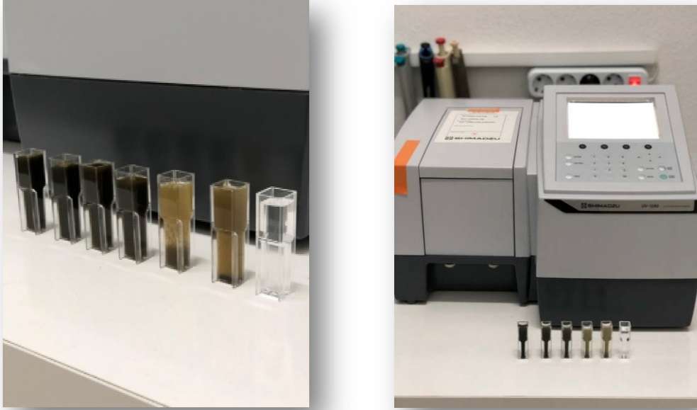
Şekil 3.3. UV/VIS Spektrofotometresi (Shimadzu UV-1280) ve analiz edilen örnekler
