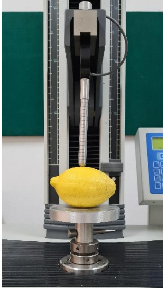
Şekil 3.3. Batıcı uç (delme) testi
