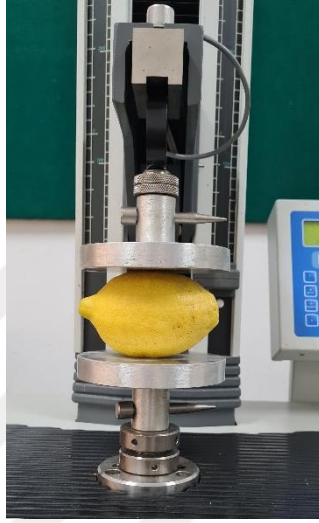
Şekil 3.2. Çift plaka arasında ezme (sıkıştırma) ve yükleme-boşaltma testi
