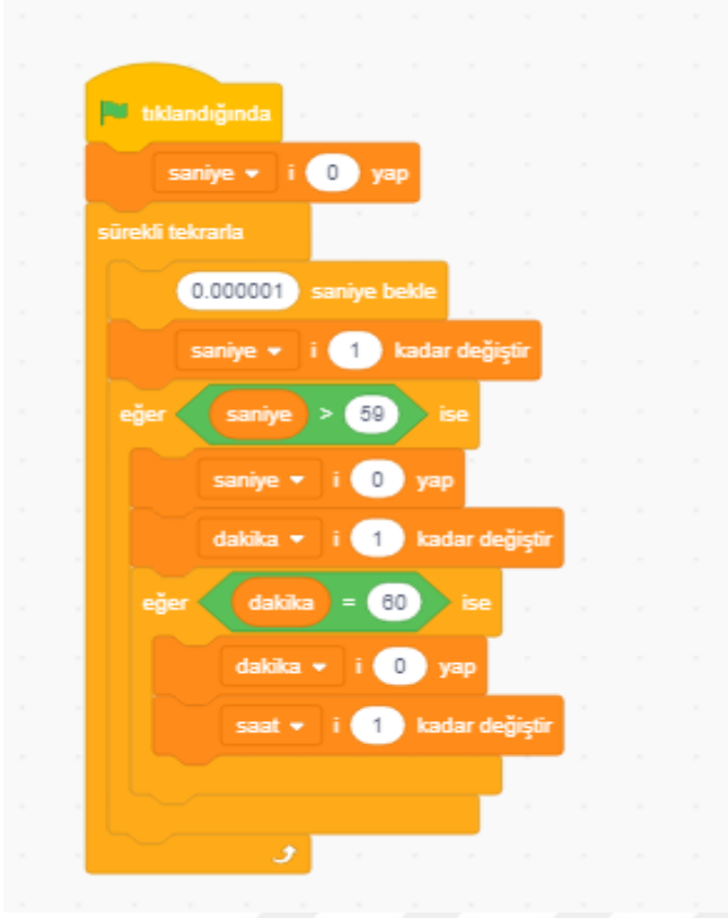
Şekil 14. Ö1 ve Ö2 saat, dakika ve saniye için oluşturdukları algoritma
