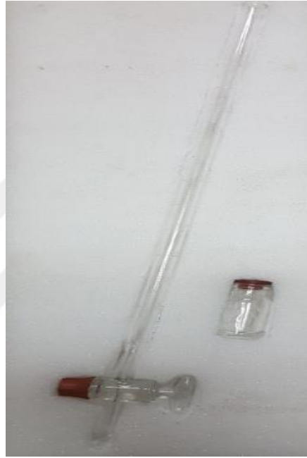
Şekil 3.5. Sıvıların yüzey gerilimlerinin belirlendiği büret ve özel toplama kabı.
