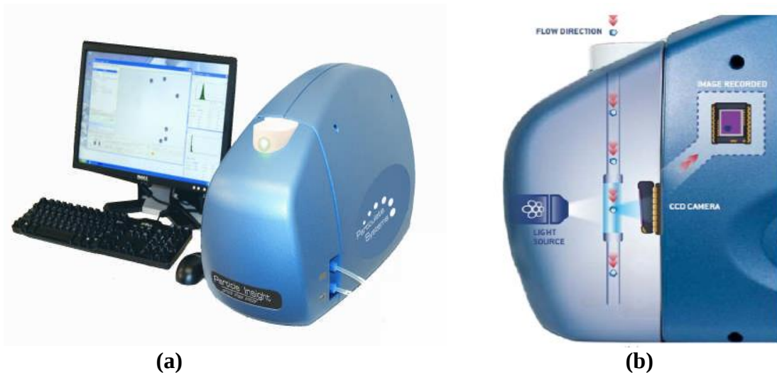
Şekil 3.11. Micromeritics® Particle Insight cihazının (a) genel görünümü (b) çalışma mekanizması ( https://www.particulatesystems.com ).
