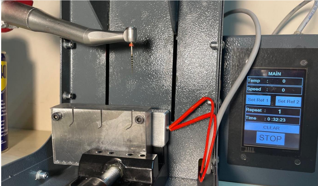
Resim 29. Dinamik Döngüsel Yorgunluk Test Düzeneği
