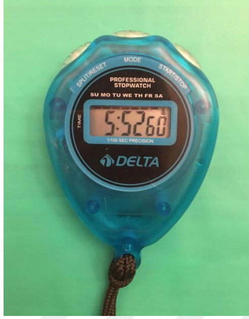
Resim 31. Kırılma anının kaydedildiği dijital kronometre
