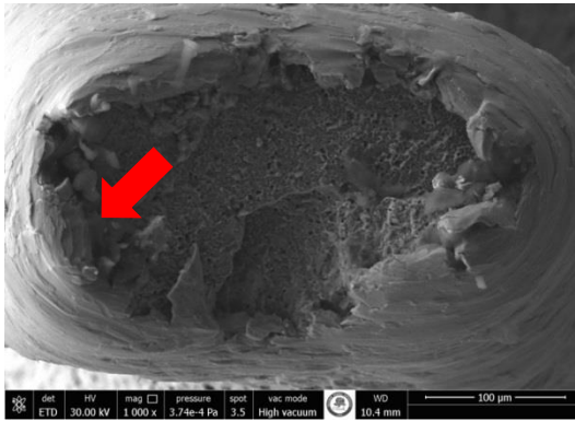
Resim 52. HyFlex EDM egesinin retreatment grubundaki 3. Kullanım grubunun X1000 ve X3000 büyütmelerdeki SEM görüntüleri (Kırmızı ok: Fleksural kırılmada görülen kırık başlangıç noktaları)
