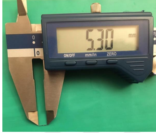
Resim 33. Eğelerin kırılan parçalarının uzunluklarının ölçüldüğü kumpas
